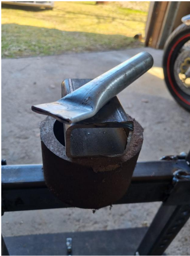
Kuva 12. Kasaan painettu putki.
