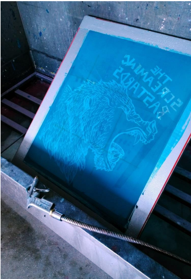
KUVA 48. ja 49. Seulan kuvan avaaminen pesemällä (Wright 2014-31-10) ja ensimmäinen painamiskierros (Wright 2014-11-03)
