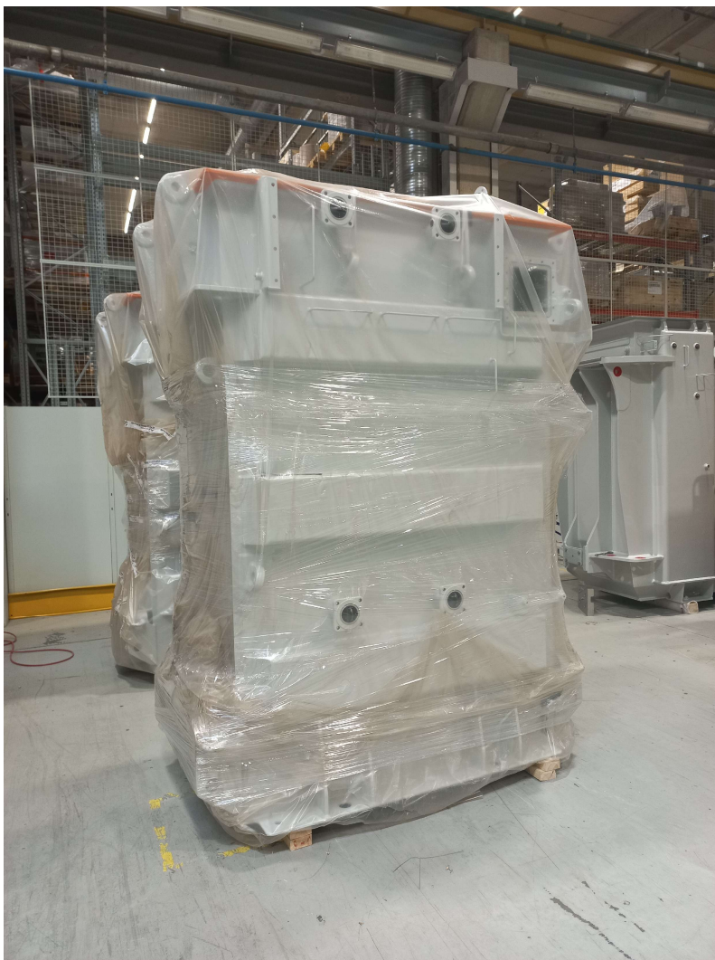
Kuva 4. Muuntajan säiliö muovitettuna.
