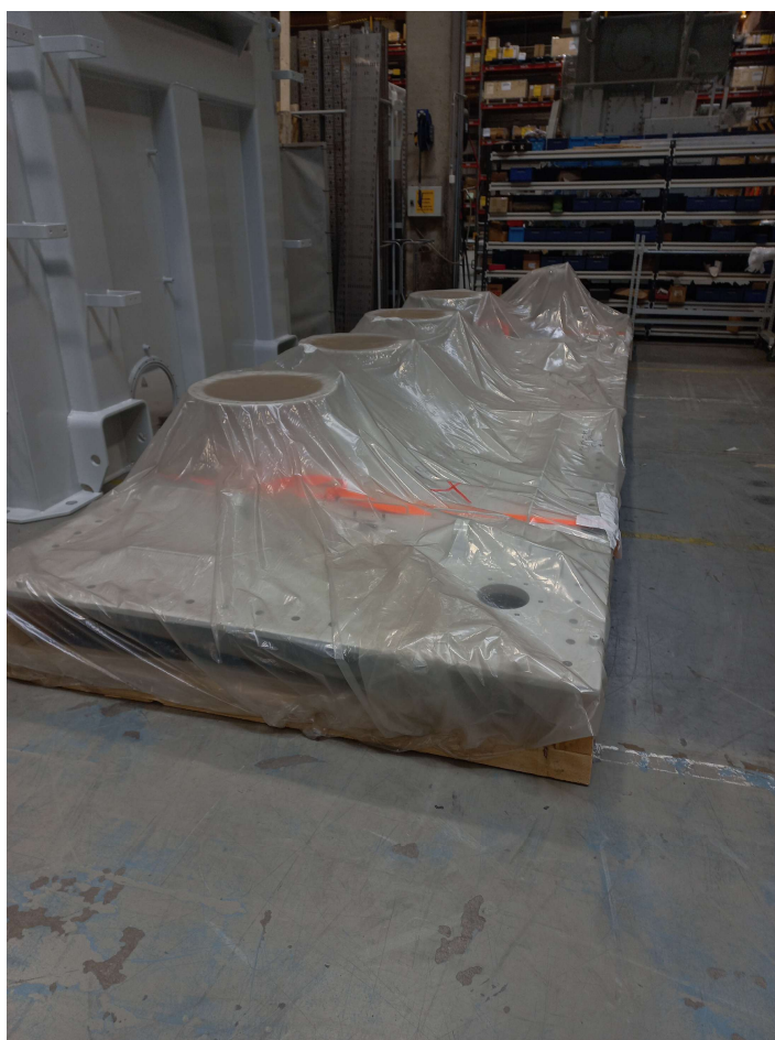
Kuva 5. Muuntajan kansi suojattuna.
