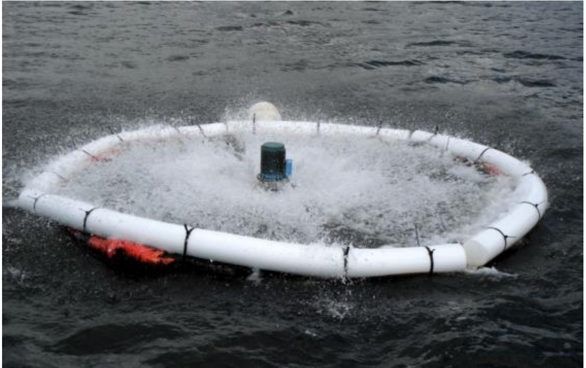
Kuva 11. Waterix AIRIT 70+ -ilmastin. (Huhta 2011)
