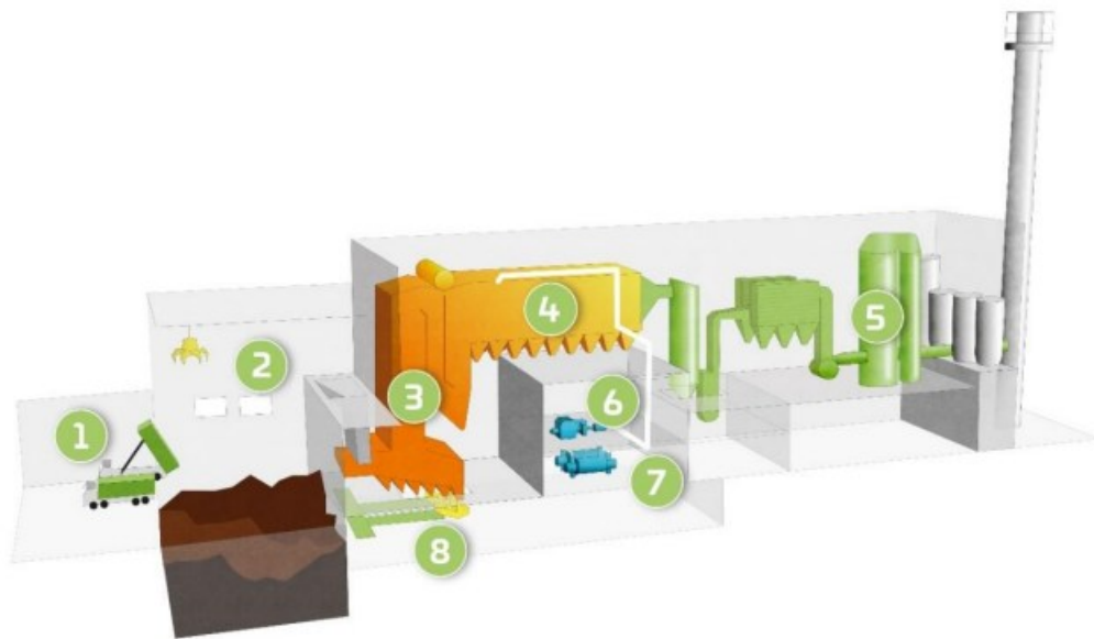
Kuva 2. Westenergyn jätteenpolttoprosessin päävaiheet: 1. Vastaanottohalli 2. Jätebunkkeri 3. Tulipesä 4. Kattila 5. Savukaasujen puhdistus 6. Turbiini 7. Lämmönvaihtimet 8. Pohjakuona. Kuva havainnollistaa jätteen hyödyntämisen eri vaiheita energiantuotannossa. (Westenergy, 2020, s. 3).
