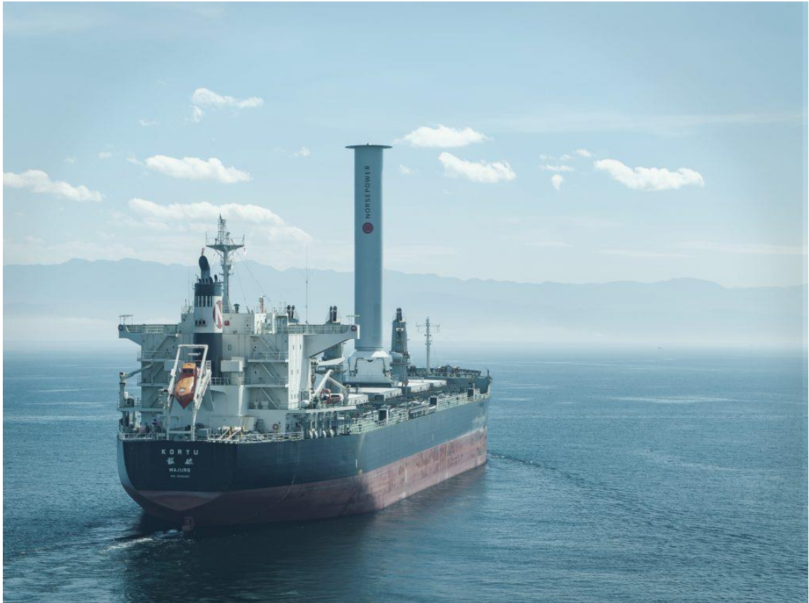
Kuva 1. Norsepowerin roottoripurjeella varustettu irtolastilaiva. (norsepower.com)
