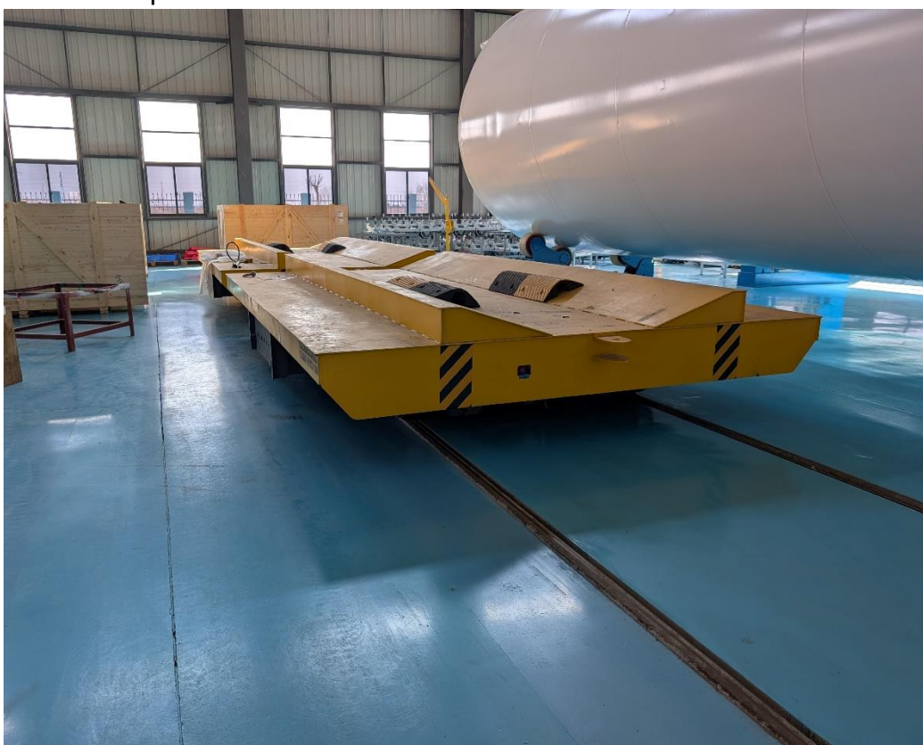
Kuva 6. Terästornien siirtelyyn käytettävä ”kehto”.
