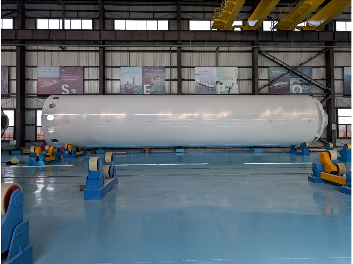
Kuva 2. Roottoripurjeen terästorni varusteltavana tehtaalla.
