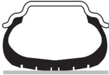
KUVA 3. Liian korkea paineinen rengas /29 s.4/
