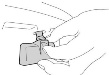
KUVA 19. Venttiilin asennus /30 s.4/
