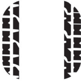
KUVA 6. Liian matalapaineisen renkaan kulutuspianta /29 s.4/
