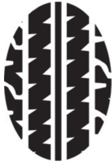
KUVA 4. Liian korkea paineisen renkaan kulutuspinta /29 s.4/
