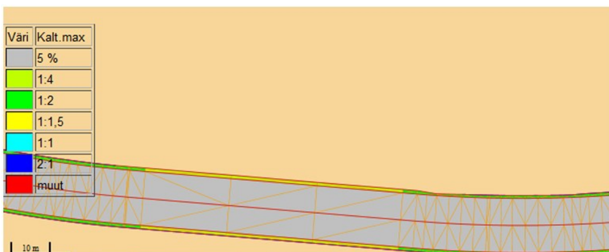
Kuva 9. Esimerkki esiintyvistä virheistä inframallissa. Kolmiointi on osittain harvaa. [14.]
