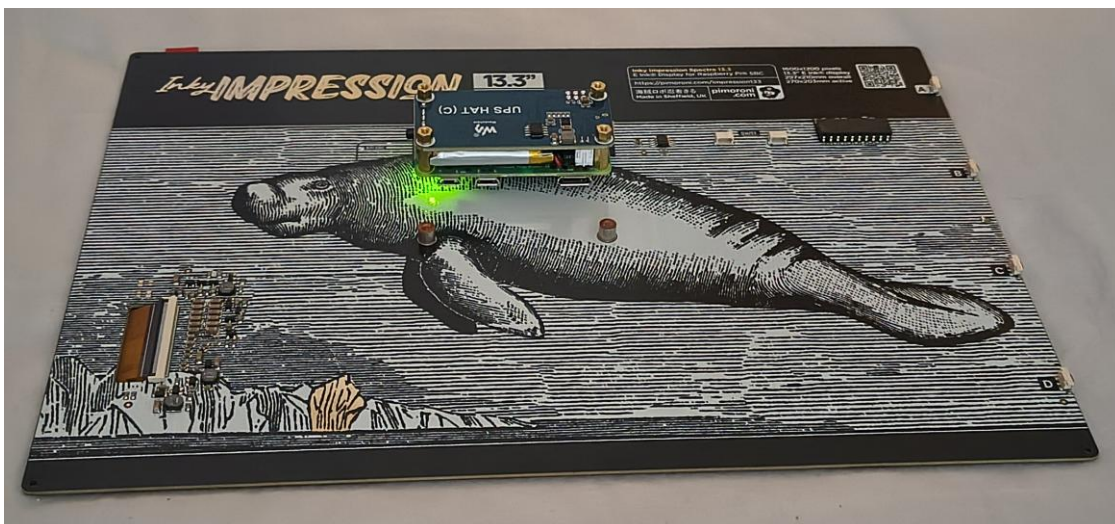
Kuva 26. Raspberry Pi + UPS HAT (C) + E Ink 13,3”-näyttö, takaa kuvattuna.
