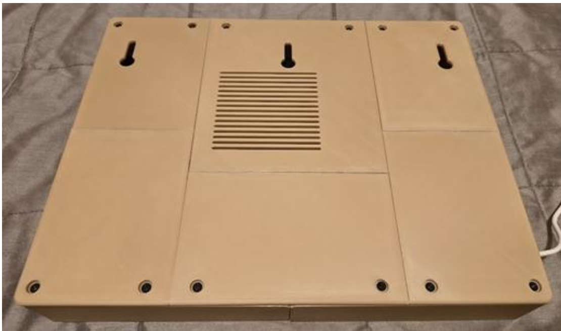
Kuva 28. Laitteisto kehyksen takaa kuvattuna, peitelevyt ruuvattuna paikalleen.
