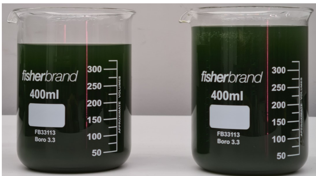
Kuva 24. Elektrokoagulaatiotestin tuotteet virralla 0,5 A (vasen) ja 1,0 A (oikea), tilavuusvirralla 2,3 ml/s.
