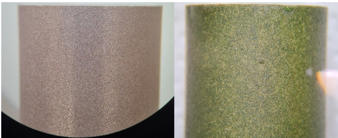
Kuva 18. Sintrattu RST-suodatinelementti 12 V elektrofiltratusta ennen ja jälkeen (8x suurennos).
