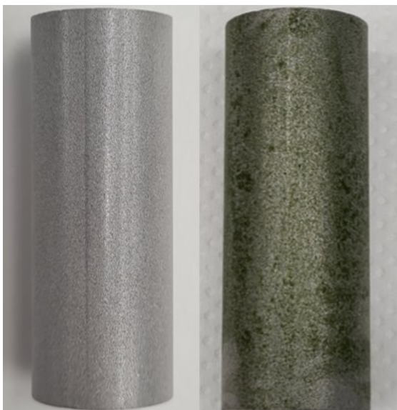
Kuva 22. RST-suodatinelementti 6 V elektro-suodatusta ennen ja jälkeen.
