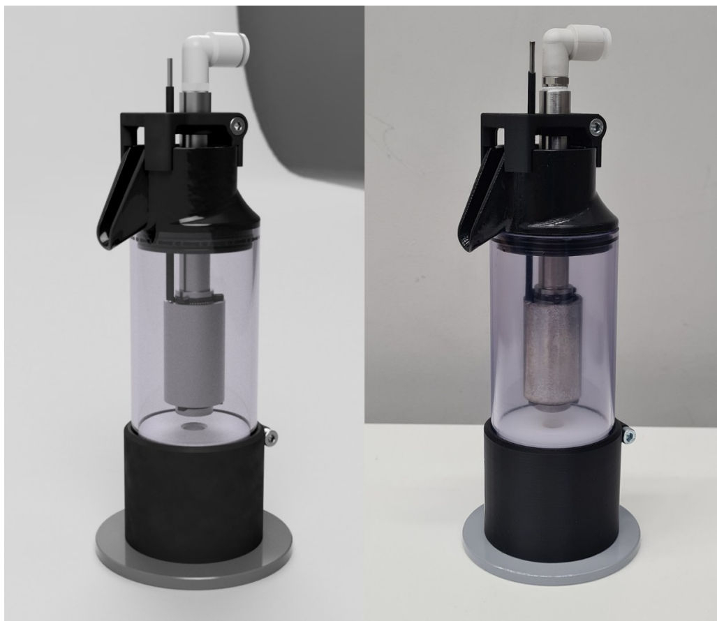
Kuva 12. Renderöinti erottelulaitteen CAD-mallista (vas.) verrattuna oikeassa elämässä rakennettuun erottelulaiteeseen (oik.).
