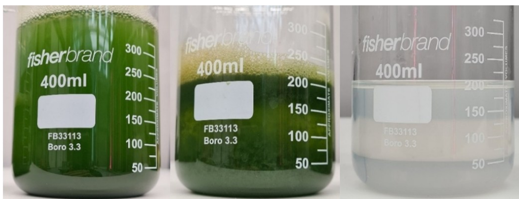
Kuva 17. 12 V Elektrosuodatustestin tuotteet. Konsentraatti (dekanteri 1 vasemmalla), konsentraatti (dekanteri 2 keskellä), suodos (oikealla).
