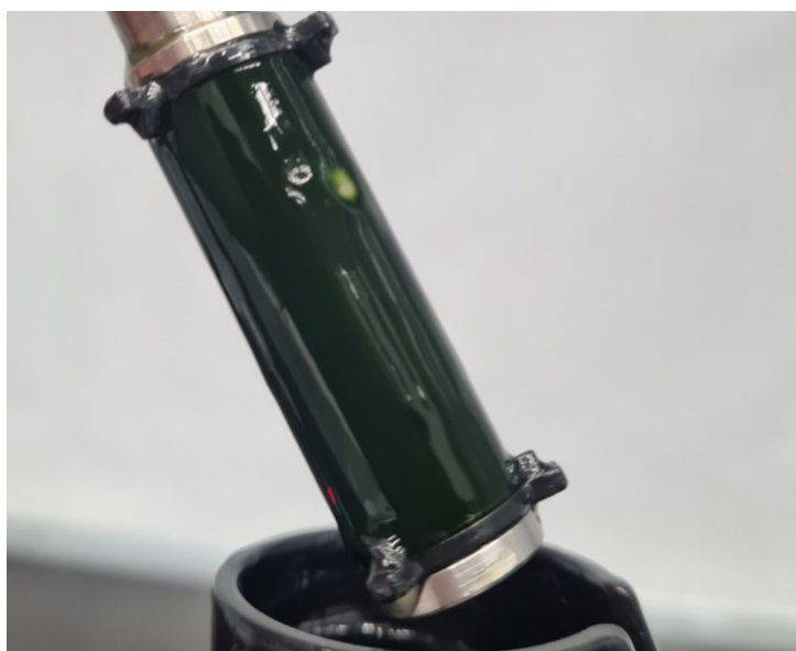
Kuva 16. Mikrosuodatuksen aikana suodattimen pinnalle kertynyt suodatinkakku.
