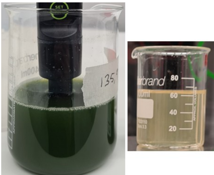
Kuva 29. Yhdistetyn elektro-suodatus ja -koagulaatiotestin tuotteet virralla 0,5 A.
