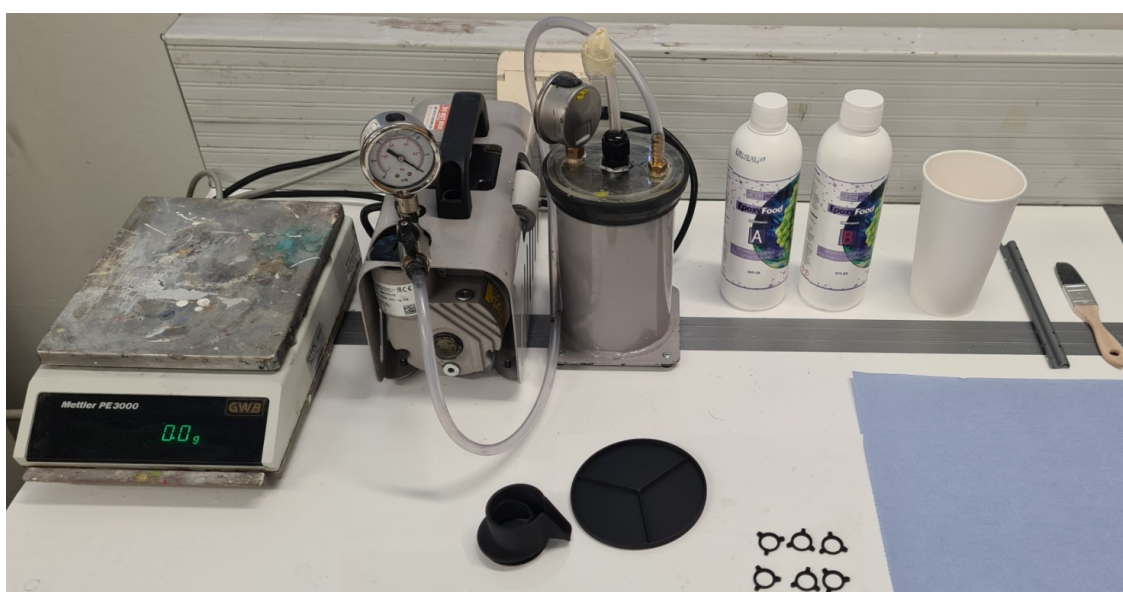
Kuva 9. Hartsipinnoituksessa käytetty laitteisto ja tarvikkeet.
