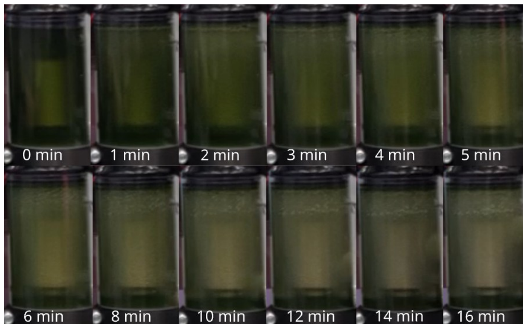
Kuva 20. Kuvasarja 12 V elektro-suodatustestissä tapahtuneesta kirkastumisilmästä.
