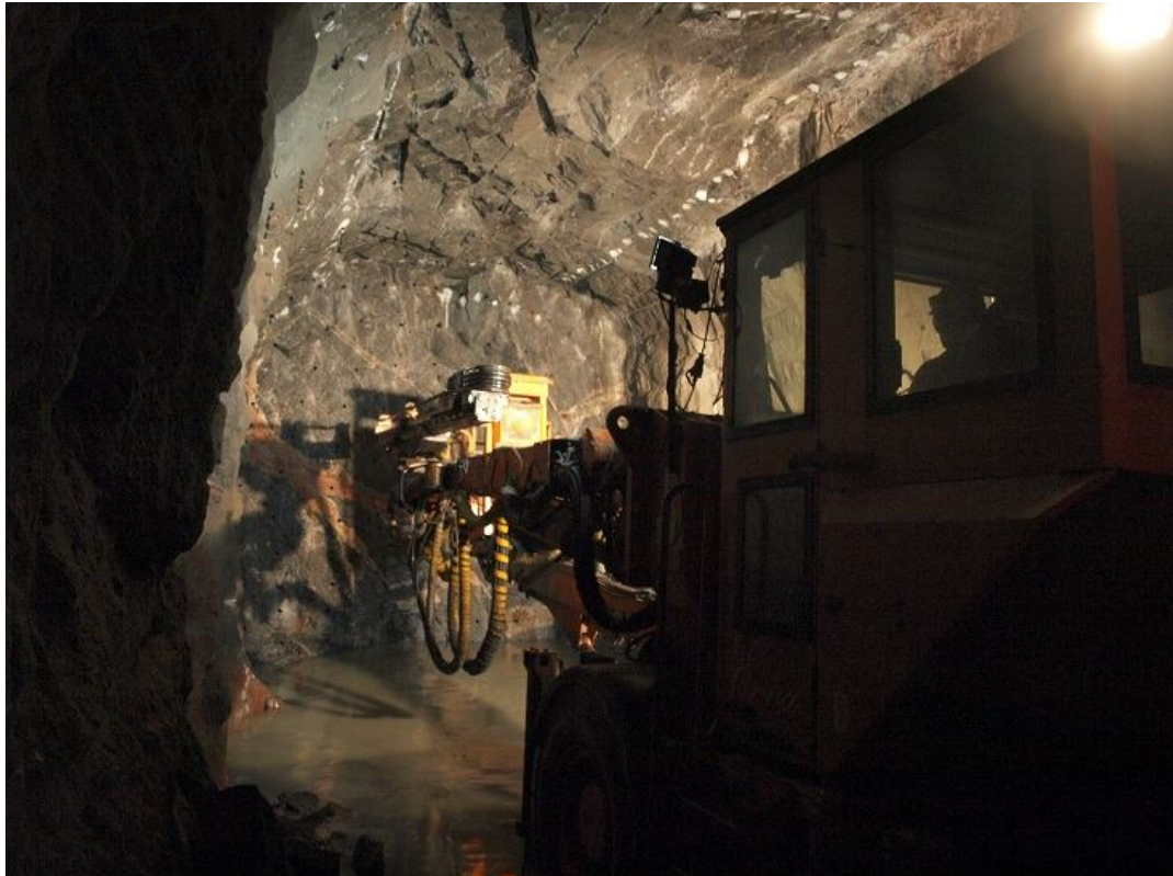
Kuva 6: Katkon porausta jumbolla
