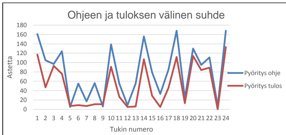
Kuvio 6. Vanhan pyörityslaitteiston toiminta ohjeen ja tuloksen suhteen C195-tukilla.
