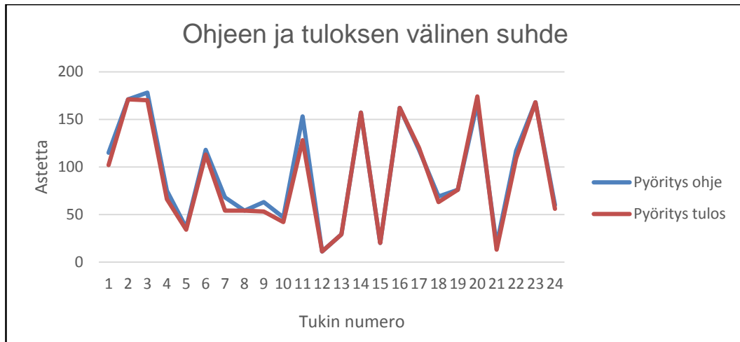
Kuvio 7. Uuden pyörityslaitteiston toiminta ohjeen ja tuloksen suhteen C195-tukilla.
