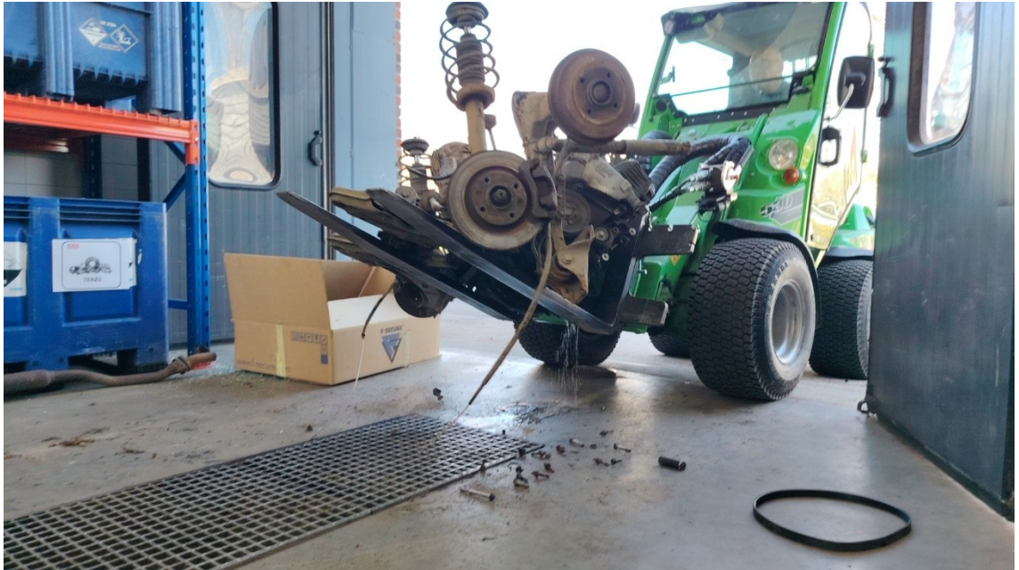
Kuva 7. Voimayksikön siirto trukilla.
