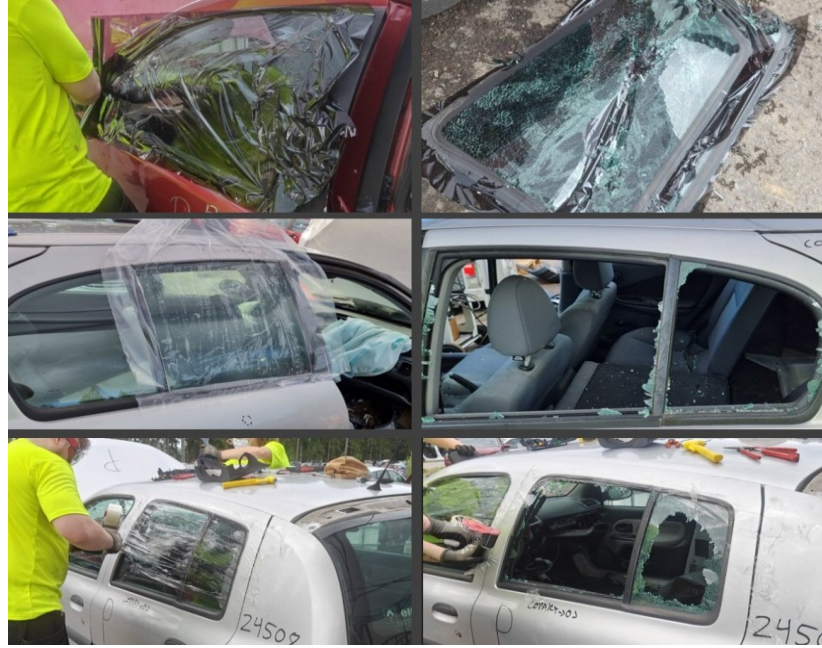
Kuva 3. Karkaistun lasin poisottoa.
