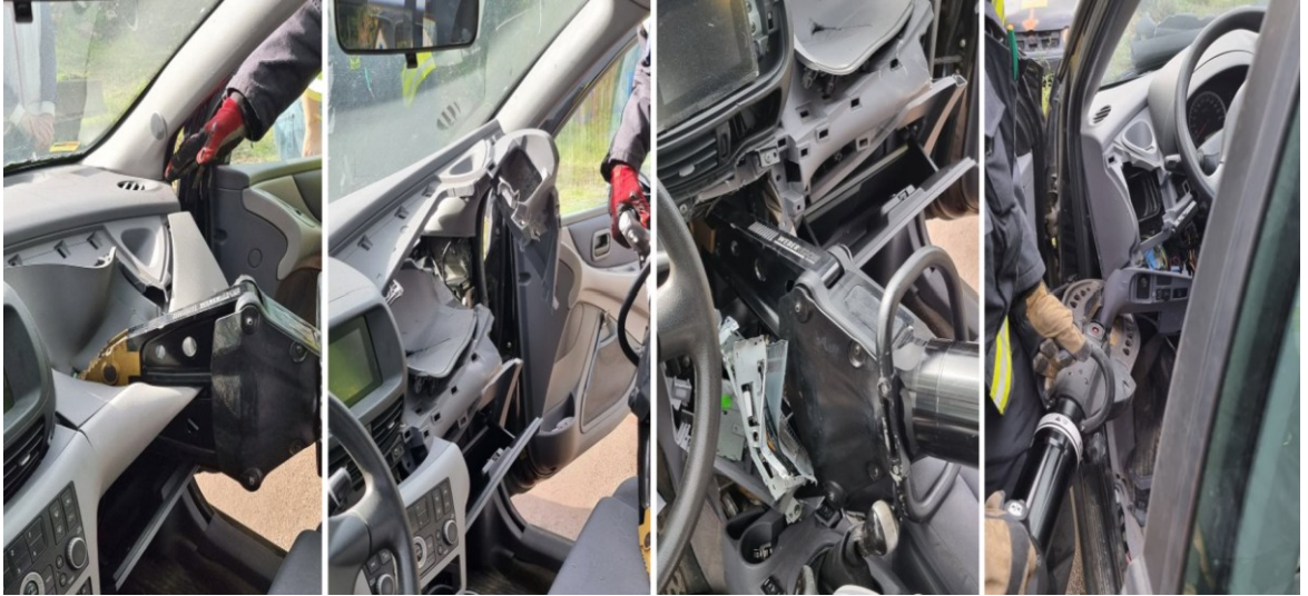
Kuva 5. Hydraulisten työkalujen testaus.
