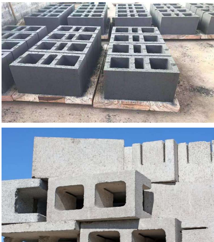
Kuva 21. Massiivinen betoniharkko-/lohkoseinä Keniassa tiili- ja betonirakenteinen seinä tarjoaa huomattavasti paremman ilmaääneneristyksen (BFT International, "TwistBlock" Kenya 2024).
