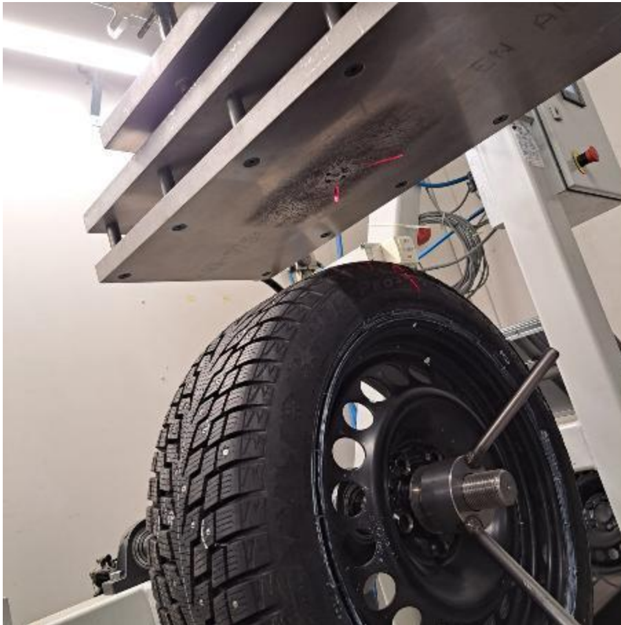
Kuva 27. Turvanastan pistovoiman mittauslaitteen mittapää.
