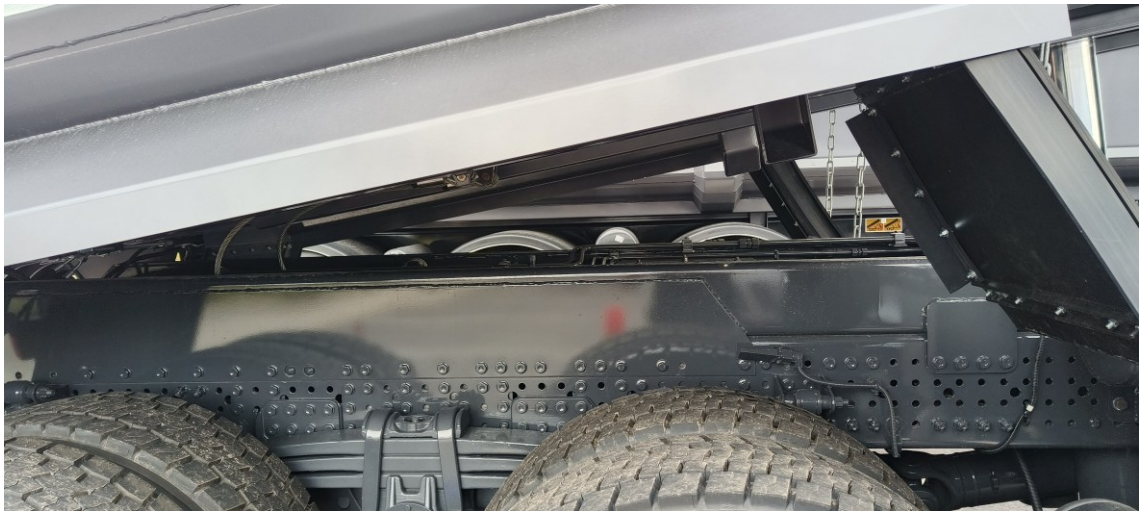
Kuva 2. Kippilavan hydrauliiikan apurunko pultattuna alustan alkuperäiseen rakenteeseen.
