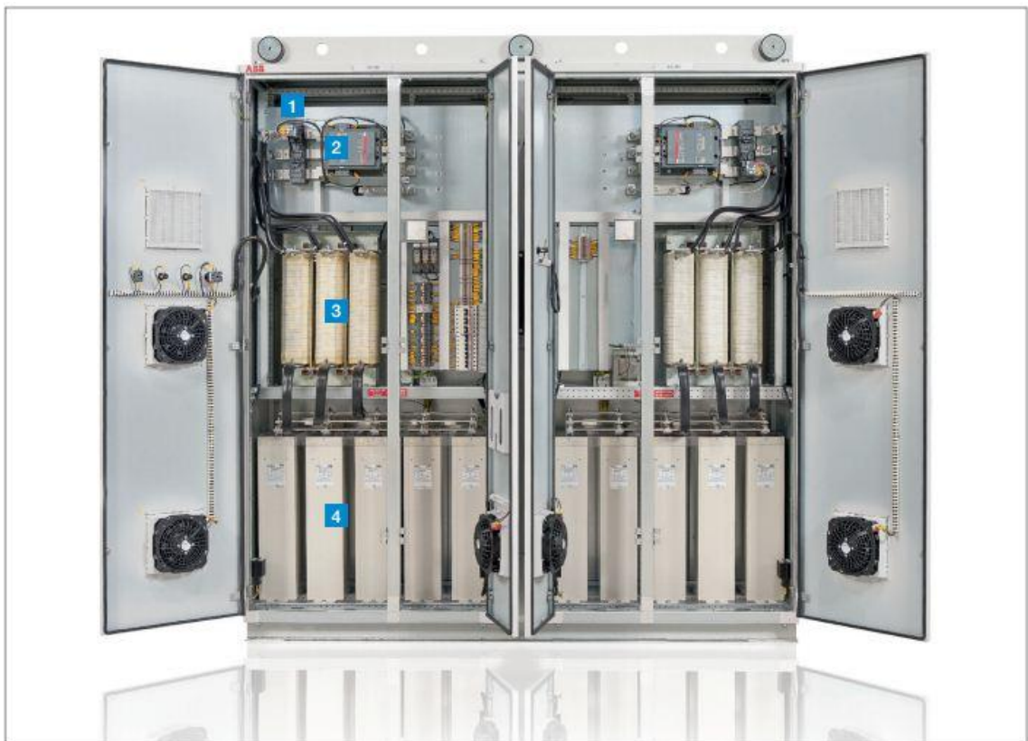
1 Lämpörele | 2 Kontaktori | 3 Kela | 4 Kondensaattorit
