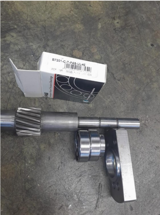
Kuvio 32. Kara-akseli, viistokuulalaakeripari, pidätinrennas ja laakeripesän kansi
