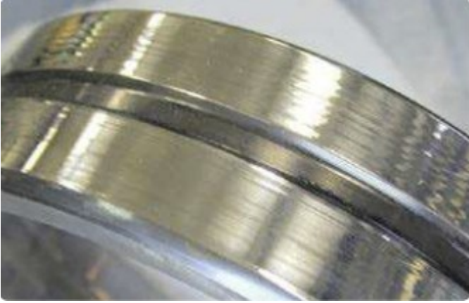
Kuvio 13. Abrasiivinen kuluminen. Laakerin ulkorengas on pyörinyt pesässä. Ulkorengas on kiillottunut (SKF-laakerien kunnossapito 2016, 300).
