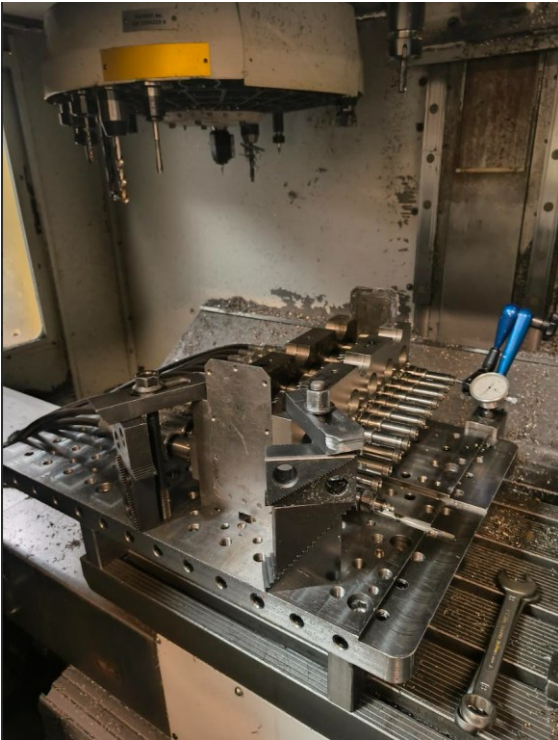
Kuvio 38. Aksiaalisenvälyksen mittaaminen.
