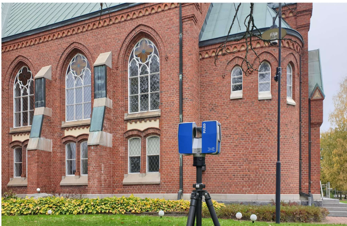
KUVA 2. Forssan kirkon ulkokuoren laserkeilausta 3.10.2024 (Kuva: Joonas Saarela 2024).
