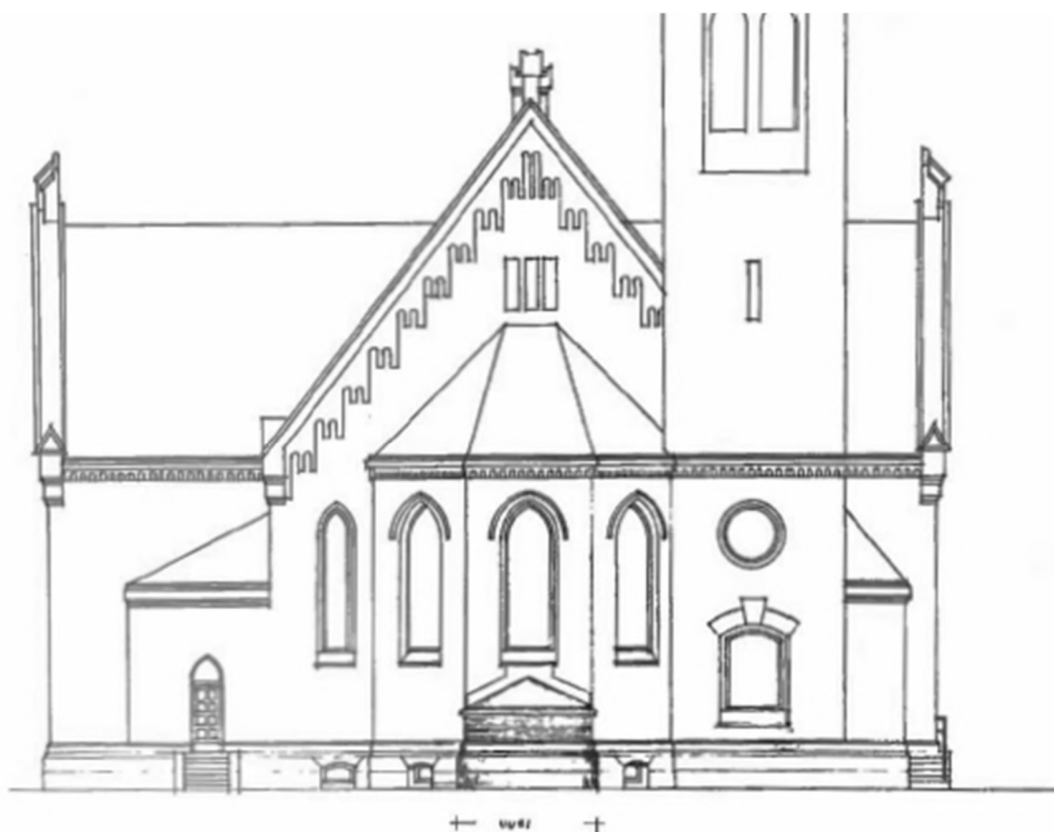
KUVA 67. Arkkitehti Yrjö Mykkäsen 27.3.1982 laatima julkisivupiirros, johon on hahmoteltu porrashuonelaajennus (Kuva: Forssan seurakunnan arkisto 1982).
