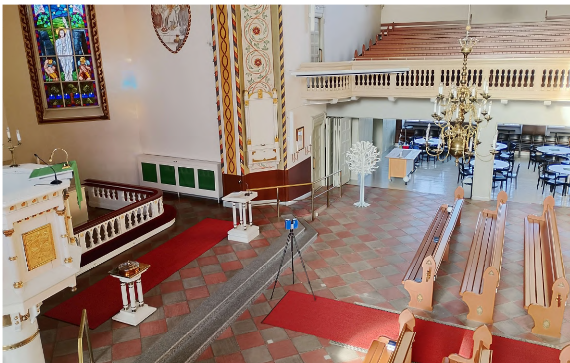
KUVA 3. Forssan kirkon sisätilojen laserkeilausta 29.10.2024 (Kuva: Joonas Saarela 2024).
