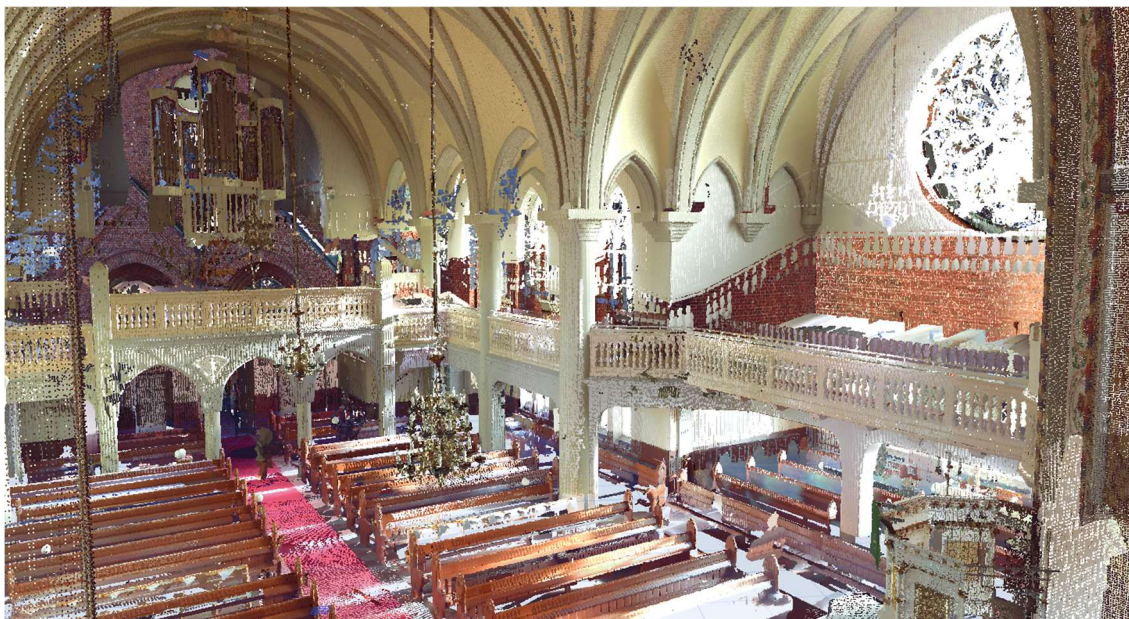
KUVA 4. Sisätiloista laserkeilatussa pistepilvimallissa pienet yksityiskohdat sekä tilaa rajaavat alakatot lisäävät pistepilvien määrää ja siten tiedoston kokoa (Kuva: Joonas Saarela 2024).
