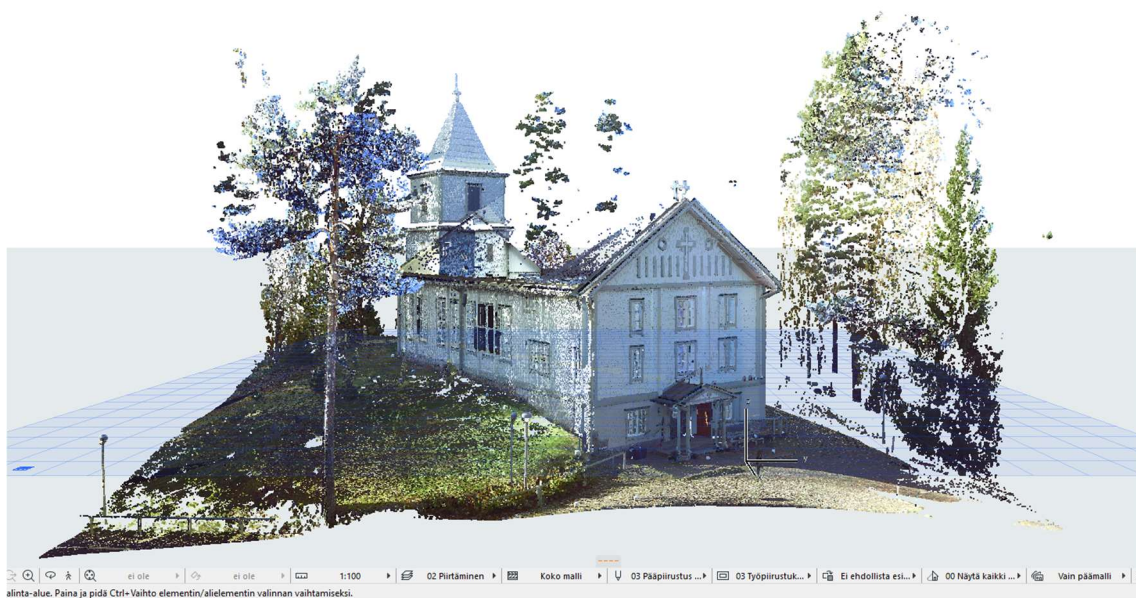
KUVA 6. Kojjärven kirkon ulkotilat laserkeilattiin Forssan kirkon lisäksi lokakuun 2024 aikana (Kuva: Joonas Saarela 2024).
