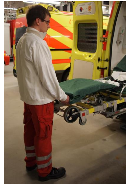
Kuva 13 Takapyörät lavetin ulkopuolella
