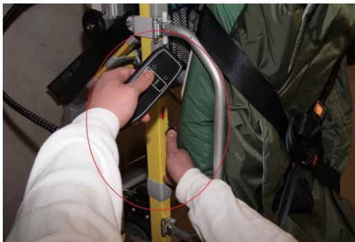
Kuva 30 Paarien nostaminen kaukosäätimellä ja etummaisten pyörien vapautus
