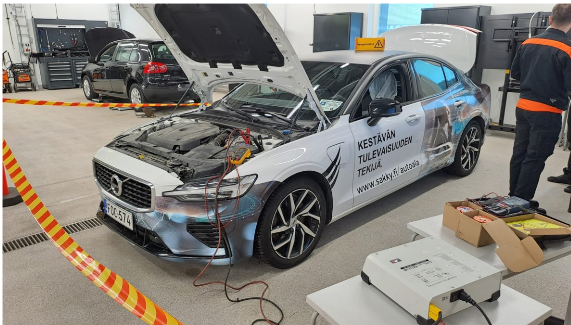
KUVA 16. Hybridiajoneuvon jännitteettömäksi tekeminen
