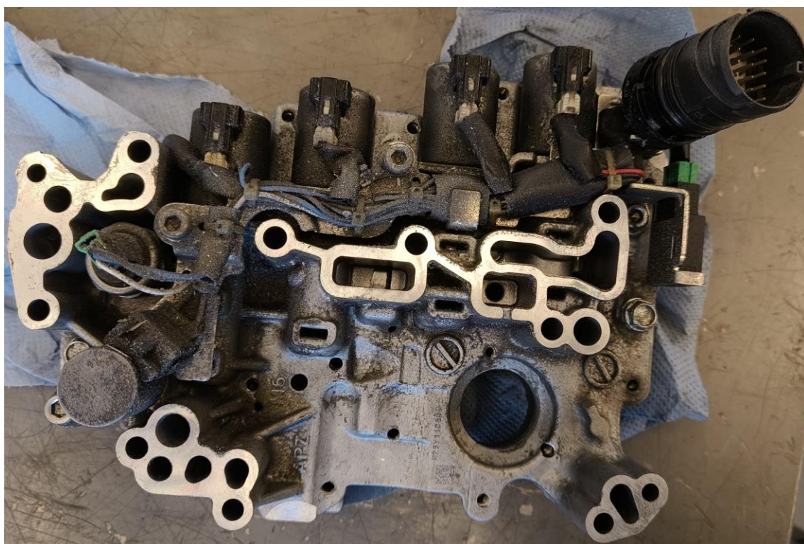
KUVA 34. Puretun vaihteiston hydraulinen venttiilikoneisto.
