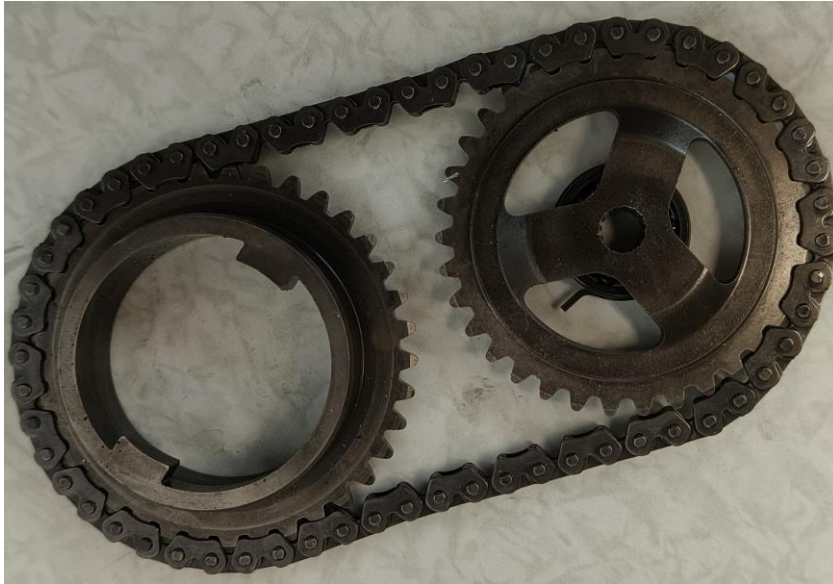
KUVA 25. Puretun vaihteiston öljypumppurattaat ja ketju
