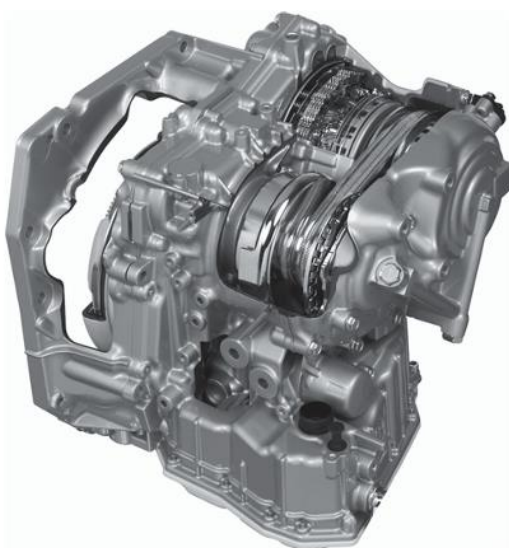
KUVA 23. Jatco CVT JF015E vaihteisto poikkileikkaus (Fischer, R. & Küçükay, F. & Jürgens, G. & Najork, R. & Pollak, B. 2015, 273)
