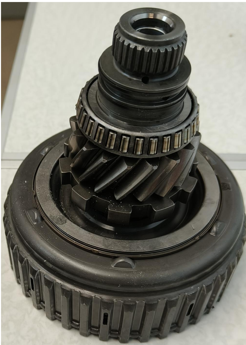
KUVA 31. Puretun vaihteiston ulostuloakseli ja kytkin- ja jarrulevyjen kotelo
