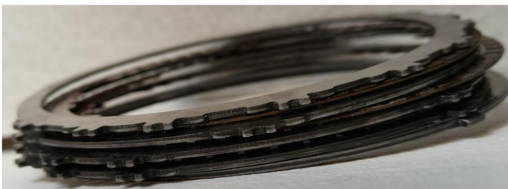
KUVA 29. Puretun vaihteiston kytkin- ja jarrulevyypakka
