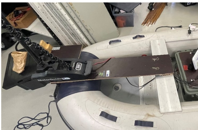
Kuva 3. Kuva pikakiinnikelevyn asennuksesta.
