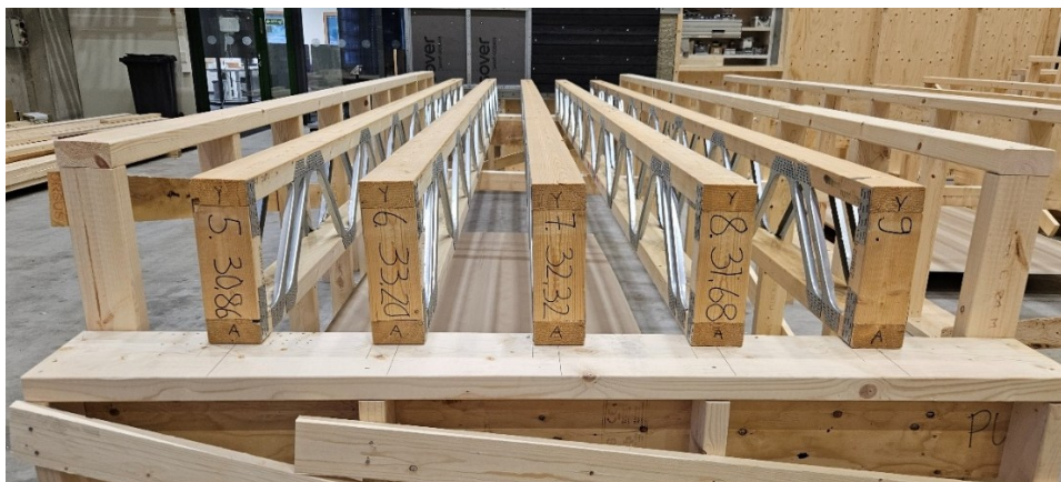
Kuva 18. Ensimmäisessä ratkaisussa on viisi kappaletta easi-joist®-palkkeja
