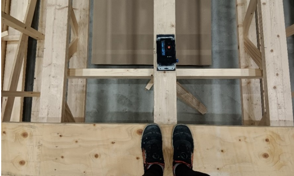
Kuva 33. Ominaistaajuuden mittaaminen heel-drop-menetelmällä (kuva: Katja Rinkinen 2025)
