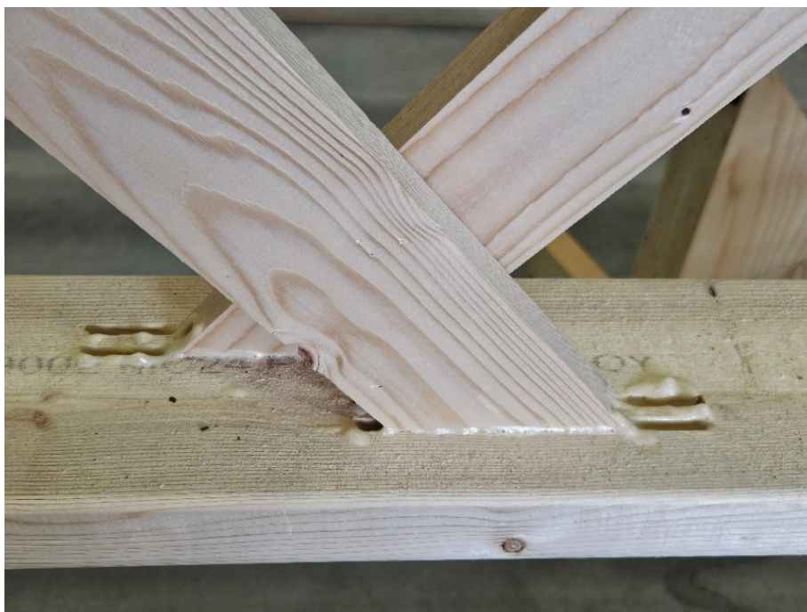
Kuva 25. TK-palkin materiaalit ja liimaus
