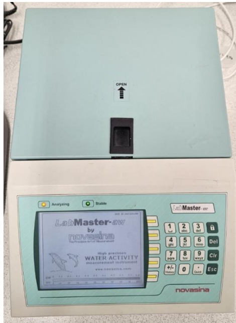
Kuva 6. Koe-erätäytteiden veden aktiivisuusmittauksiin käytetty mittari, Novasina AG LabMaster aw
