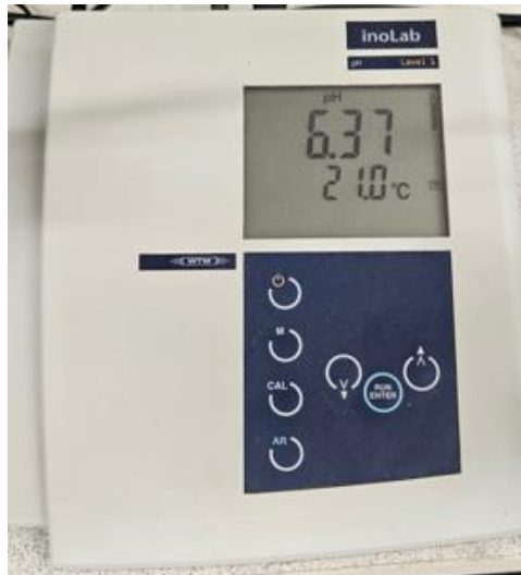
Kuva 5. Koe-erätäytteiden pH-mittauksiin käytetty mittari, inoLab pH Level 1
