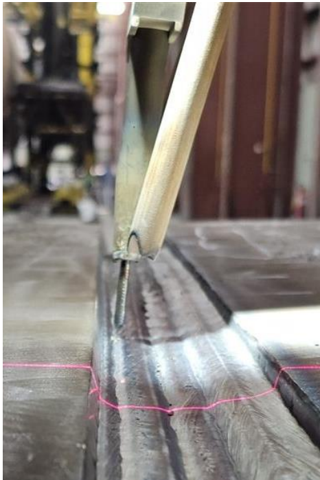
Kuva 7. Kallistetut SAW-hitsauspolttimet ja laser-railonseurannan valosäde
