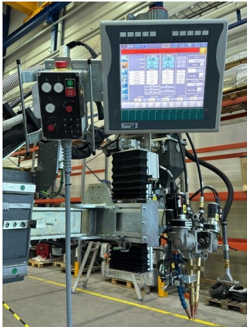
Kuva 6. WC100 Käyttöliittymä ja RC1-ohjain istuimellisen hitsaustornin ohjaukseen
