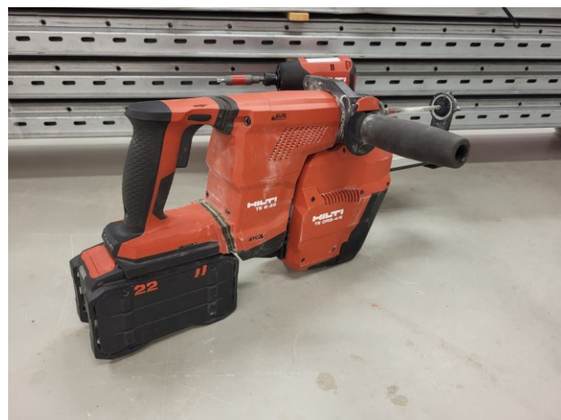
Kuva 9. Akkukäyttöinen poravasara kohdepoistolla (Juho 2024)
