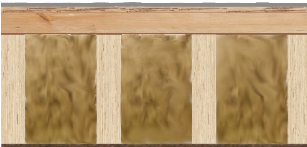
Figur 6. En digitalt sammanställd skärning genom bottenbjälklaget, den övre delen av bilden motsvarar konstruktionens insida (illustrationen är inte skalenlig). (Rönnblad,2025).
