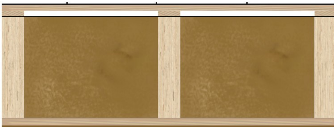
Figur 8. En digitalt sammanställd skärning som visar takkonstruktionen för ett plåttak, övre sidan av bilden motsvarar utsidan där man kan se takplåten (illustrationen är inte skalenlig). (Rönblad, 2025).
