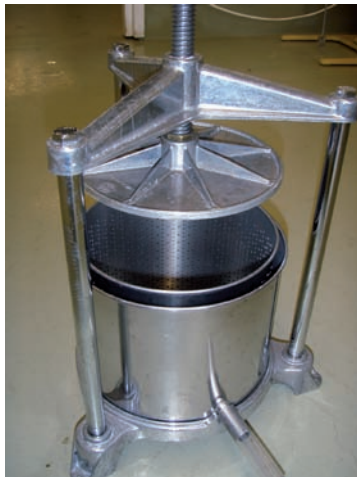
Kuva 6. Herukoiden mehustuksessa käytetty 4,5 l:n mehupuristin (Palumbo) (vas.) ja omenoiden mehustuksessa käytetty 40 l:n vesipainepuristimella (EPL 740) (oik.).
