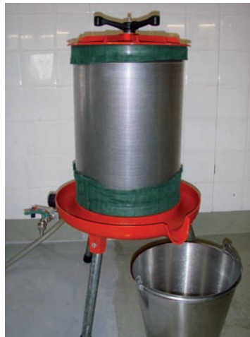
Kuva 6. Herukoiden mehustuksessa käytetty 4,5 l:n mehupuristin (Palumbo) (vas.) ja omenoiden mehustuksessa käytetty 40 l:n vesipainepuristimella (EPL 740) (oik.).
