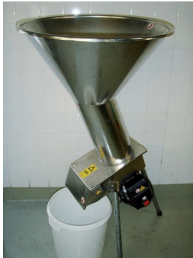
Kuva 5. Omenamurskain (EPL 23 Mixer, Enotecnica Pillan).
