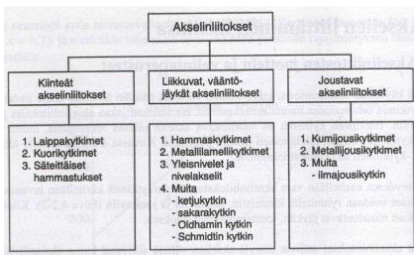
KUVA 1. Akselinliitosten jaottelu. (Airila ym. 2003, 344.)
