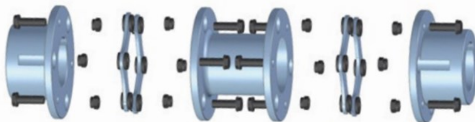
KUVA 3. Jaure Lamidisc SX-lamellikytken osat. (Jaure 2025.)
