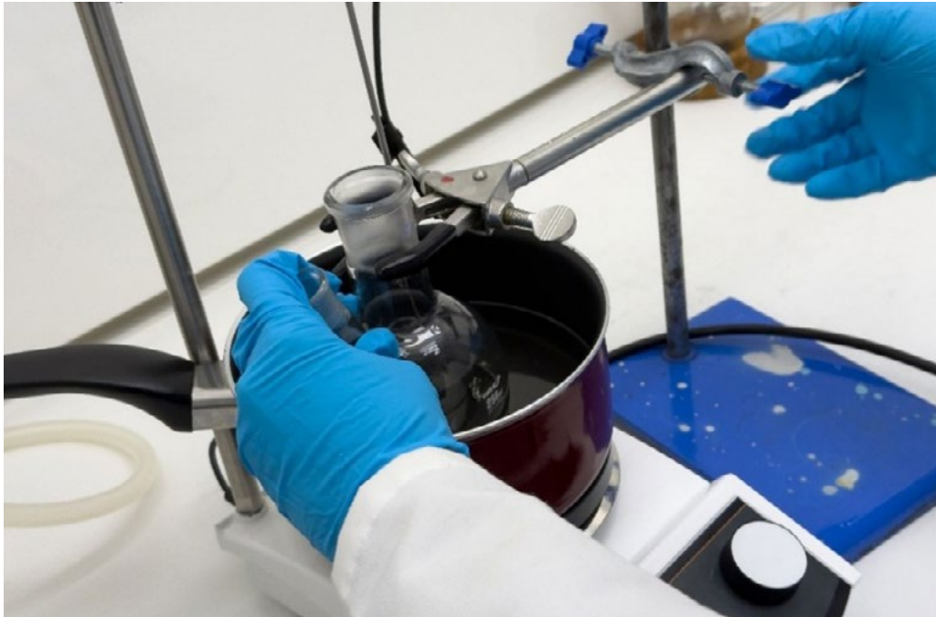
Kuva 1. Solvolysikoe: Lasikuidun ja hartsin erottaminen. Kuva: Harri Joensuu.
