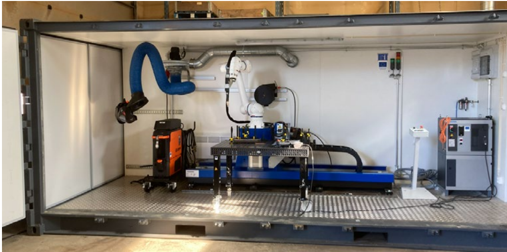
Siirrettävä robotisoitu hitsaussolu. Kuva: Centria-ammattikorkeakoulu.
