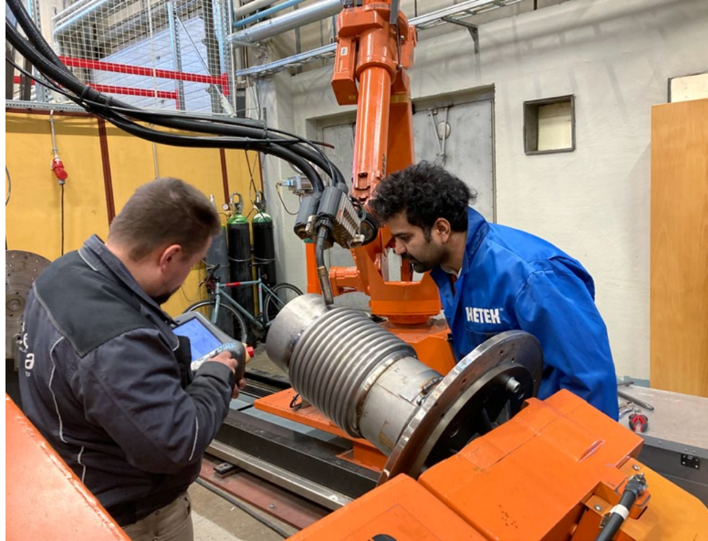
Centrian asiantuntijat tarkastelevat robotin hitsaamaa saumaa. Kuva: Joonas Pesio.
