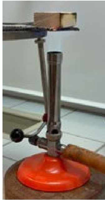
Kuva 2. Koeasetelma puukappaleen palotestaukselle.
