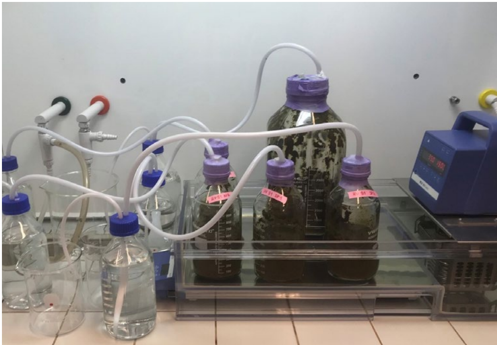
Laboratoriomittakaavassa pienillä näytemäärillä suoritettavat mädätyskokeet ohjaavat pilot-mittakaavan kokeiden syöte- ja lisäainevalintoja. Kuva: Emilia Niittyviita.
