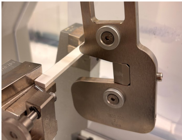
Kuva 12. Näyte tukien varassa, CEAST 9050 Impact Tester
