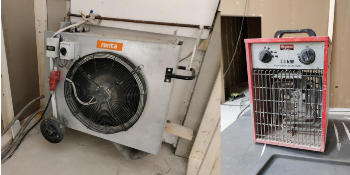
KUVA 6. Vasemmalla kiertovesilämmitin, oikealla rakennuslämmitin
