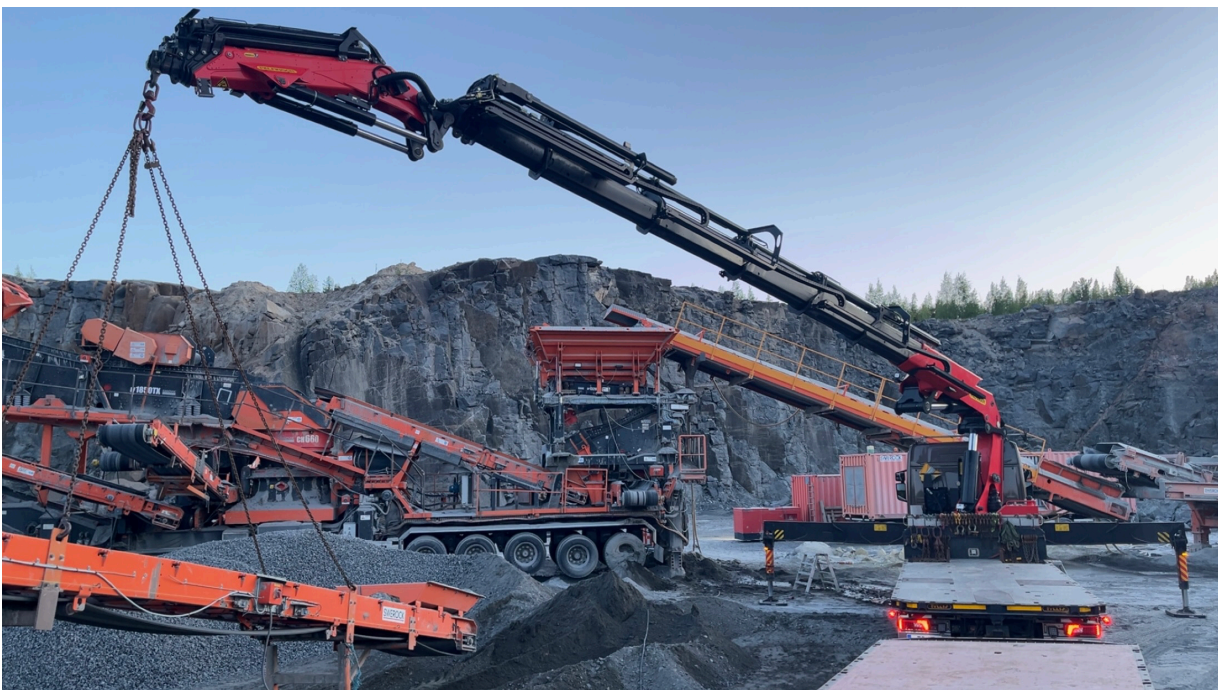
Kuvio 1. Lastaaminen asennusnosturilla "jibi" puomia hyödyntäen.
