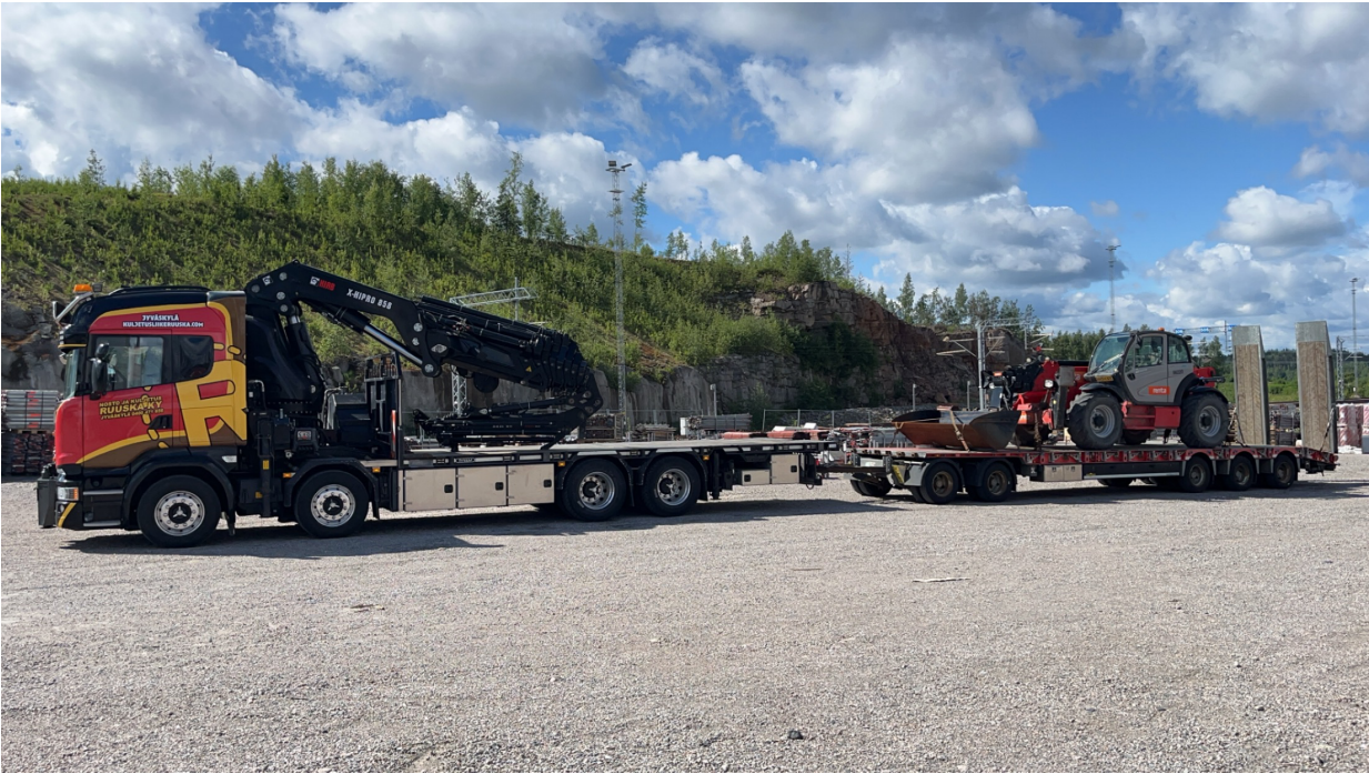
Kuvio 2. Kuorman lastaaminen ajamalla kyytiin.
