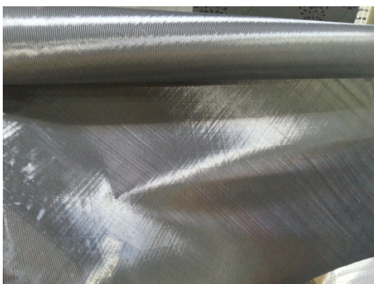
Kuva 8 XC 411 on 45 asteen kulmaan kudottua mattoa. Tiheintä ja kestäväntä, mitä kuivalaminoinnissa käytetään.
