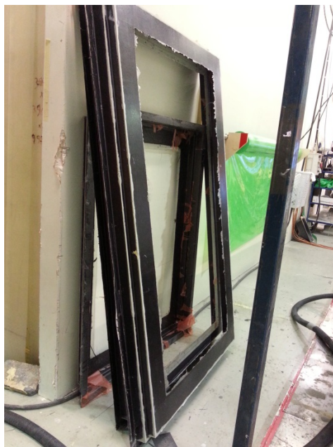
Kuva 21 Seuraavana päivänä saamme ihastella laminaattia kovettuneena ja valmiina vietäväksi pintakäsittelyosastolle. Kulmissa näkyvät harmaat alueet ovat SvaPondia.
