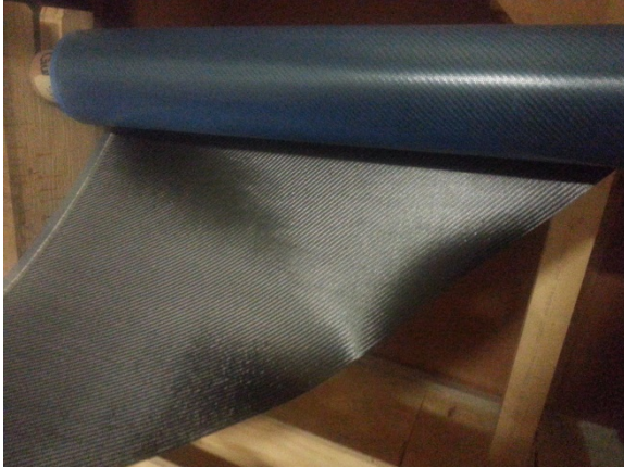
Kuva 10 XC 400 Prepreg mattoa. Nimen merkintä tarkoittaa, että kuidut on kudottu x:n mallisesti 45 asteen kulmaan toisiinsa nähden ja matto on 400mm leveää.
