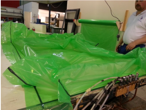
Kuva 19 Kun muovi ja muovin tasaisen asettumisen muotin päälle mahdollistavat veikit on paikallaan, laminaatti on valmis imua varten. Kuvassa myös Jonny Svenfelt.
