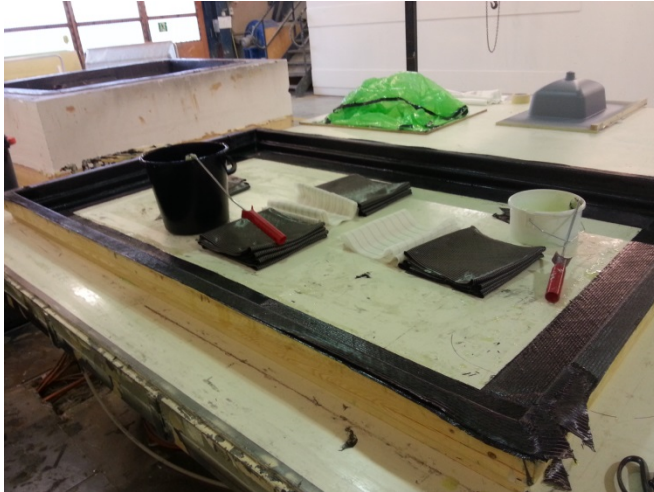
Kuva 14 Ensimmäiset kaksi kerrosta hiilikuitua on laminoitu. Esileikatut hiilikuitu matot on aseteltu muotin ympärille niin, että yhden sivun matot ovat yhdessä kasassa, jotta pysyy tarkka luku valmiista kerroksista.
