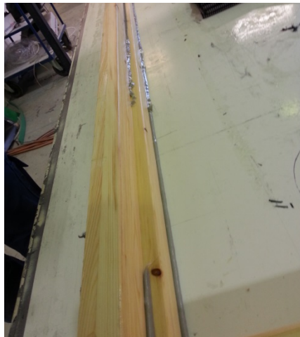
Kuva 13 Muotin esivalmistelua. Muotin liian teräviin kulmiin asetetaan SvaPond-kittiä, koska käyttämämme hiilikuitumatto ei taivu alle viiden millimetrin pyöristyksiin.
