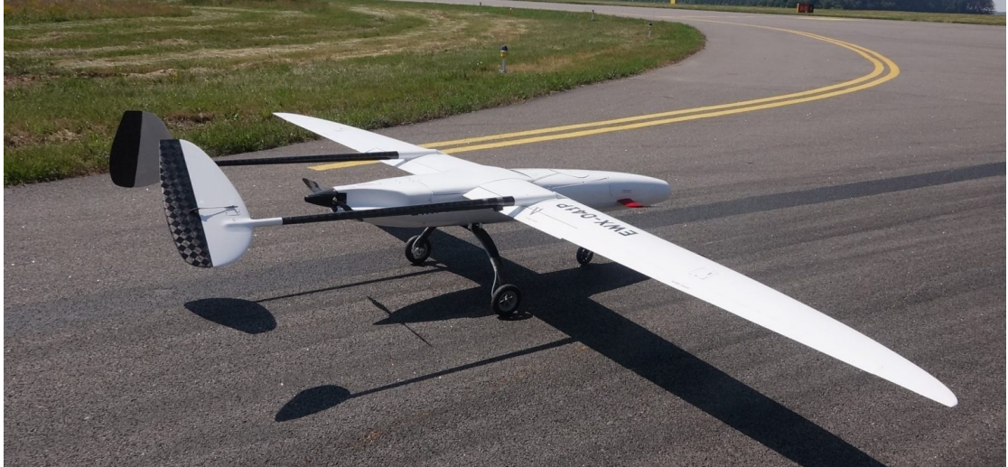
Kuva 3. Kiinteäsiipinen droni. Kiinteäsiipinen droni pystyy lentämään kovempaa ja pidempiä matkoja, mutta ei ole välttämättä yhtä ketterä kuin nelimoottorinen droni. (UAVOS, S.a)
