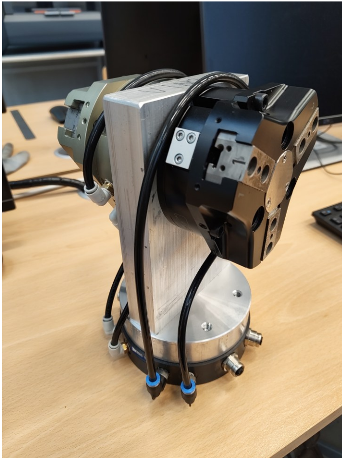
Kuva 18. Tarrainten kiinnitys alumiiniseen välikappaleeseen.
