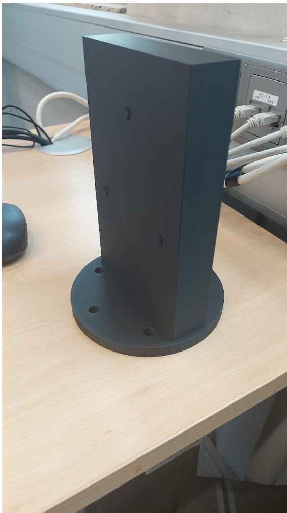
Kuva 13. 3D-tulostettu kiinnityksen ensimmäinen versio robotin tarttujille.
