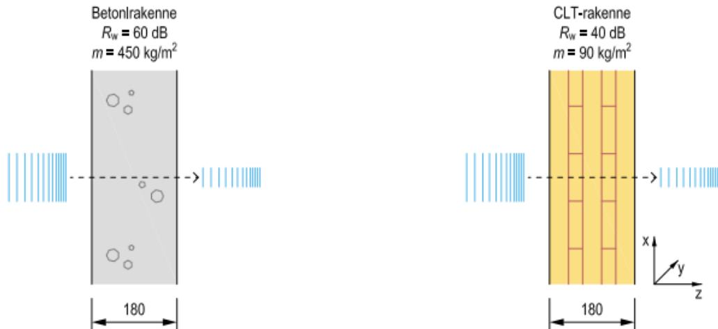
Kuva 10. Yksinkertaisen seinärakenteen ääneneristävyys (Puuinfo 2021, 21)
