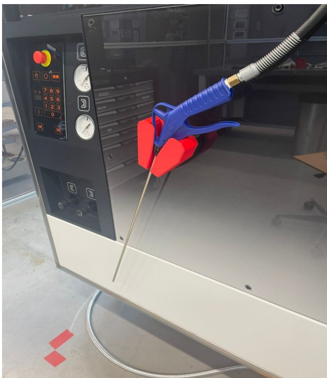
Kuva 6. Ratkaisu paineilmapistoolin sijoitukselle.
