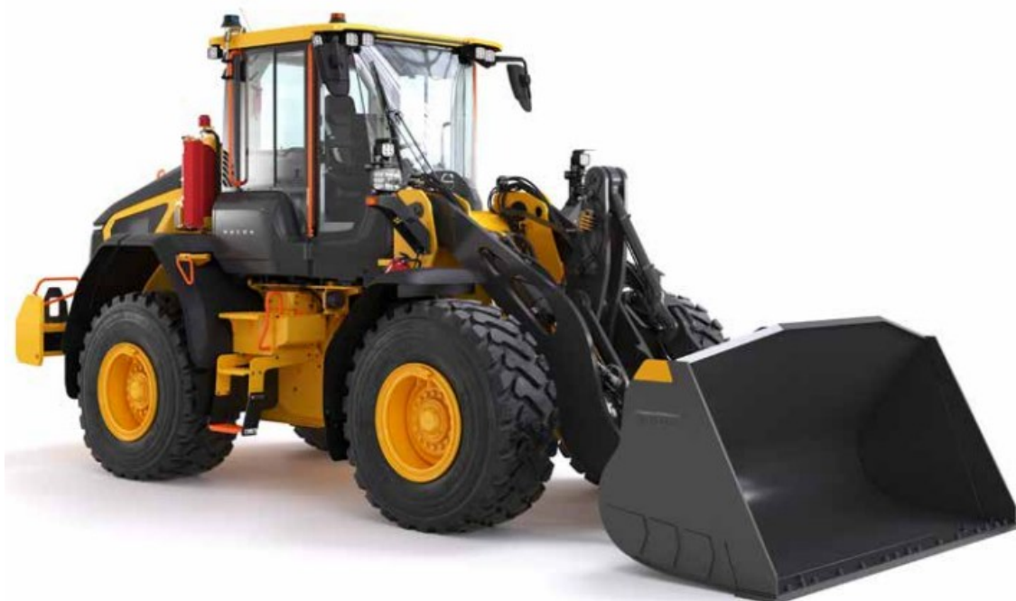
Kuva 6. Kuvassa sähkökäyttöinen Volvo L90 Electric. Kuormaajan ulkonäkö ei juurikaan eroa polttomoottoriversiosta (Volvo, 2025.)
