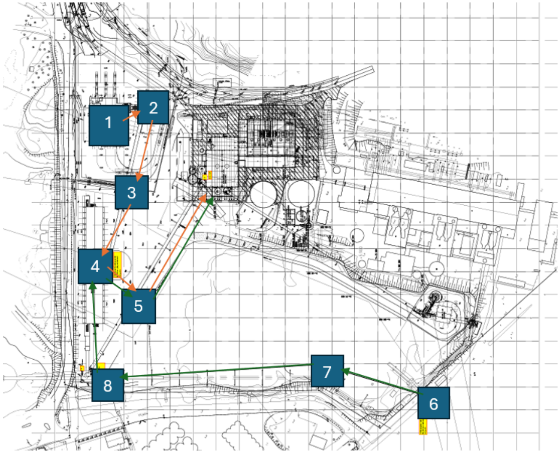
Kuva 39. Havainnollistava kuva polttoaineen kulusta Naantalın voimalaitoksella.
