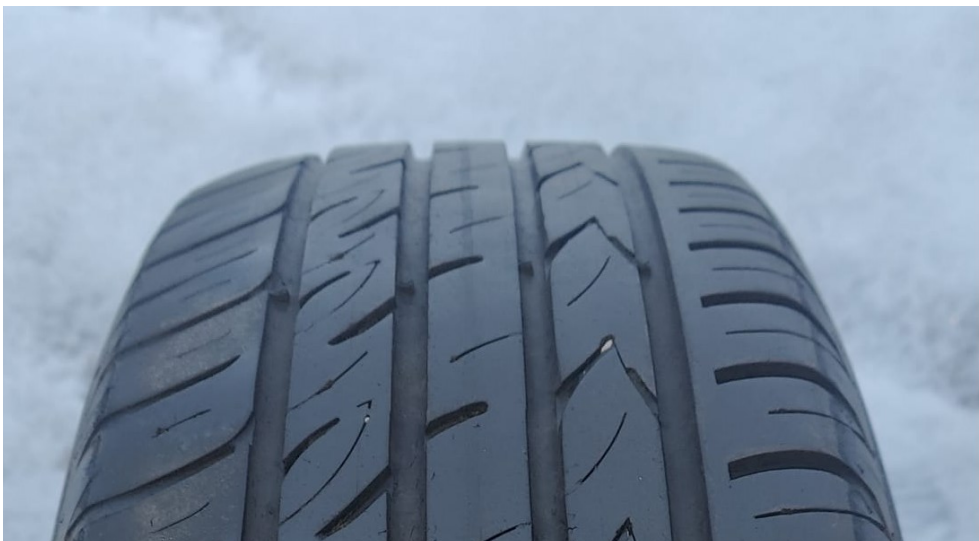
Kuva 9: Auton kesärenkaan kulutuspinnan neljä leveää pääuraa. (Kuva: Tytti Leskelä)
