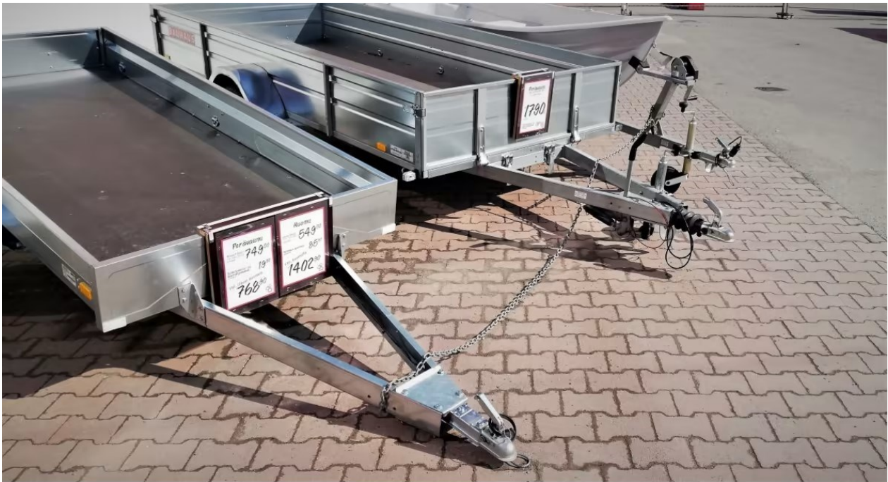
Kuva 13: Vasemmalla O1-kevytperävaunu ja oikealla O2-luokan perävaunu, jonka aisassa on jarru. (Kuva Marcus Ziemann, Yle. 14.4.2020)
