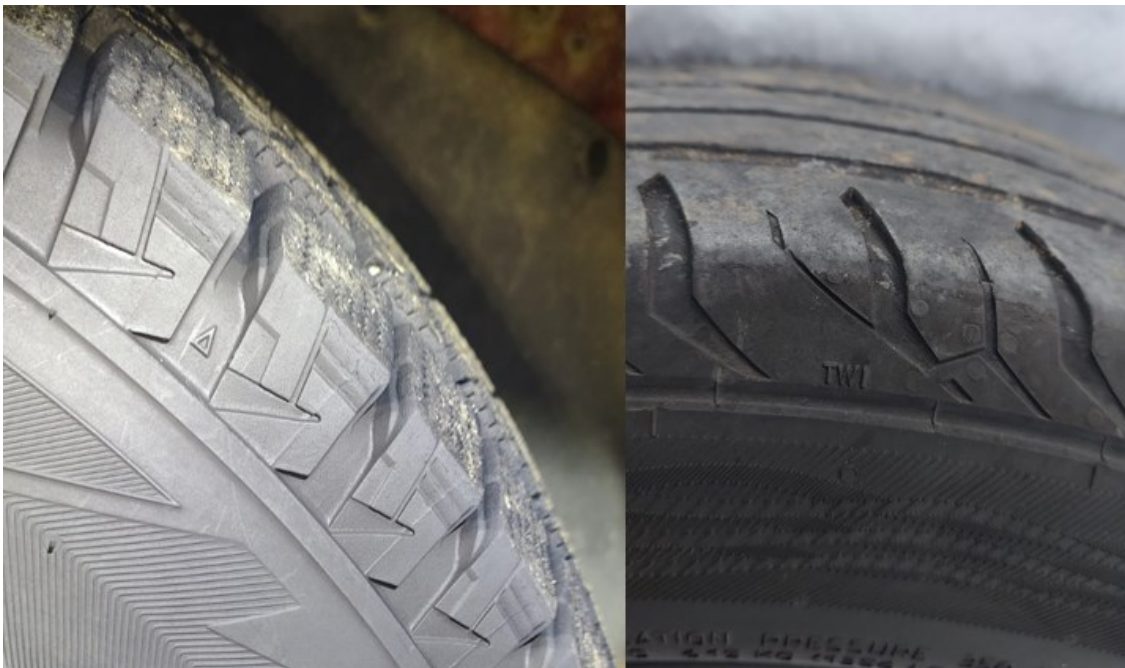
Kuva 4: Vasemman kuvan renkaassa kulumisvaroitimet löytyvät kolmion kohdalta ja oikeanpuoleisessa kirjainten TWI kohdalta. (Kuva: Tytti Leskelä)
