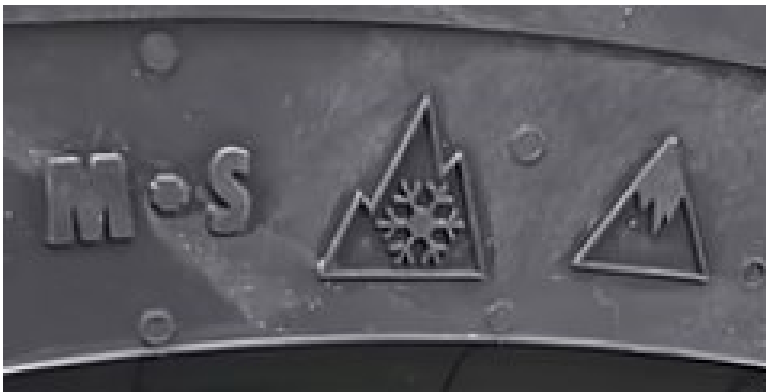
Kuva 5: Tätä nykyä riittämätön M+S, "Vuoristomerkinä" eli 3PMSF sekä "Jääpitomerkinä" eli IGS. (Kuva: Wikimedia Commons, 6.1.2026)
