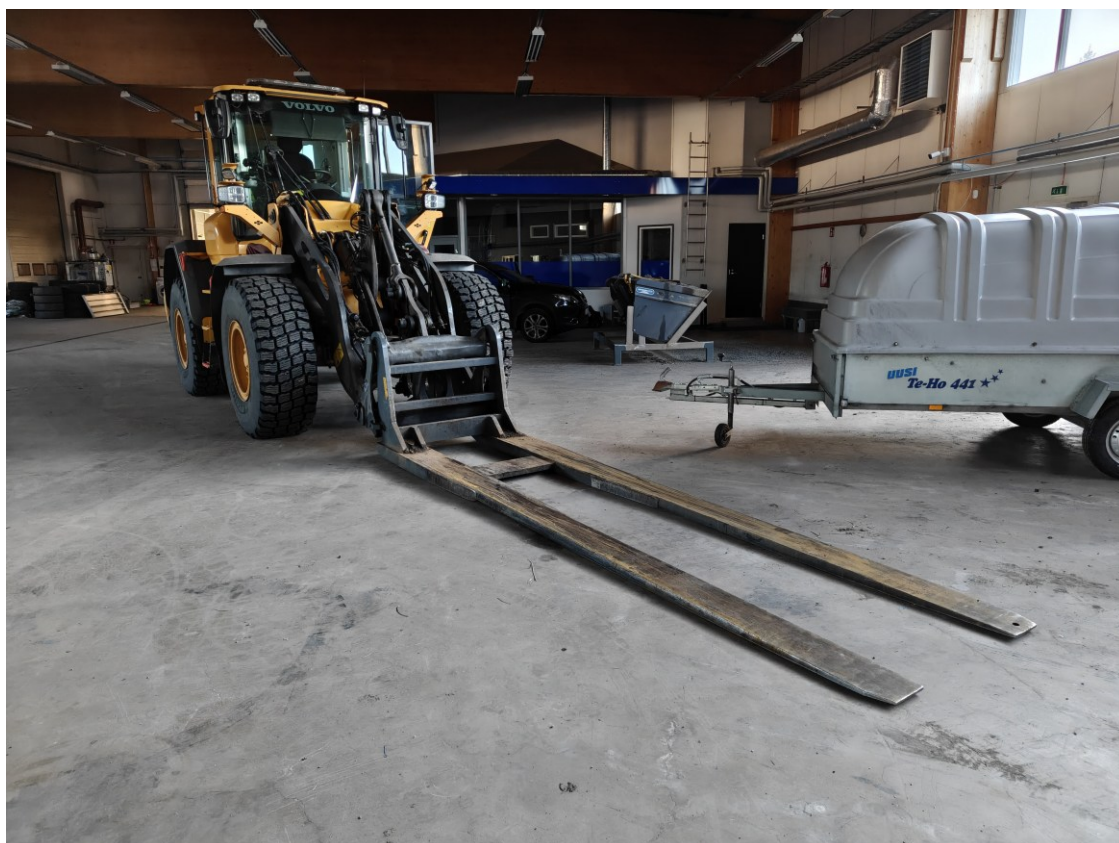
Kuva 1. Pyöräkone ja trukkipiikit (Kuva: Jonas Silfverberg).
