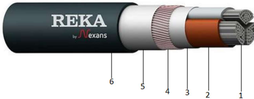
Kuvio 23. Voimakaapelin AMCMK U_0, U, U_m/0,6, 1, 1.2 kV rakennekuva (Mukailen Rexel 2025a)
