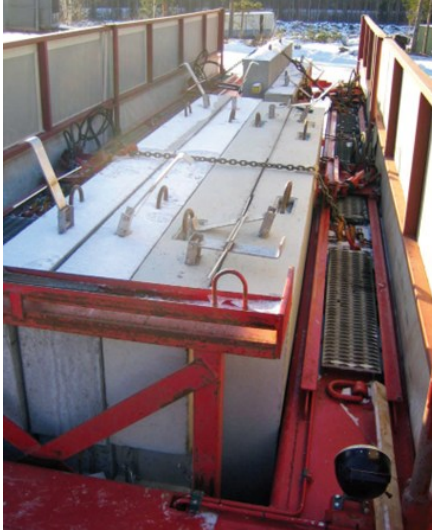
Kuvio 19. Seinäelementtien kuljetusta allasautolla (Elementtisuunnittelu 2025c)
