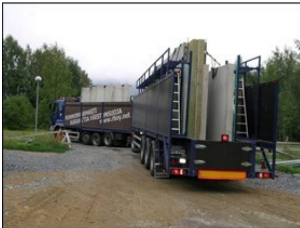
Kuvio 18. Seinäelementtien kuljetusta täysperävaunulla (Elementtisuunnittelu 2025c)
