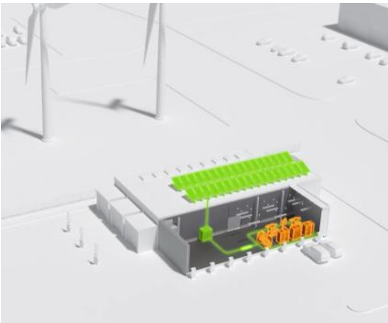
KUVA 1. Paikallisesti tuotetun energian varastointi akkuvarastoon (mukaiillen Cactos Oy 2024)
