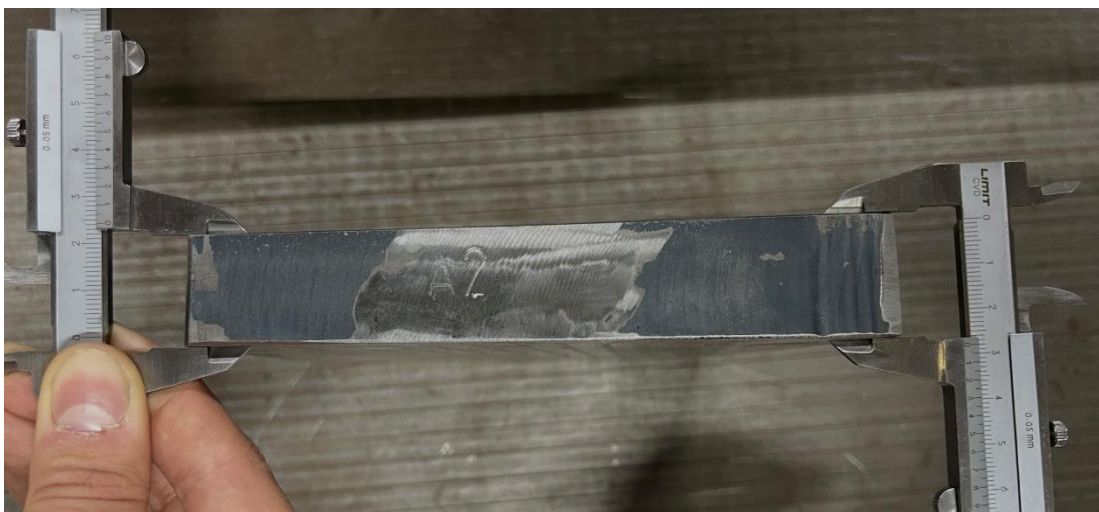
Kuva 7. Teräsklossi, josta näkee selkeästi sen kiilamaisuuden
