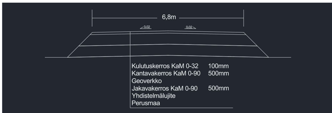
Kuvio 7. Geoverkkorakenteen poikkileikkaus
