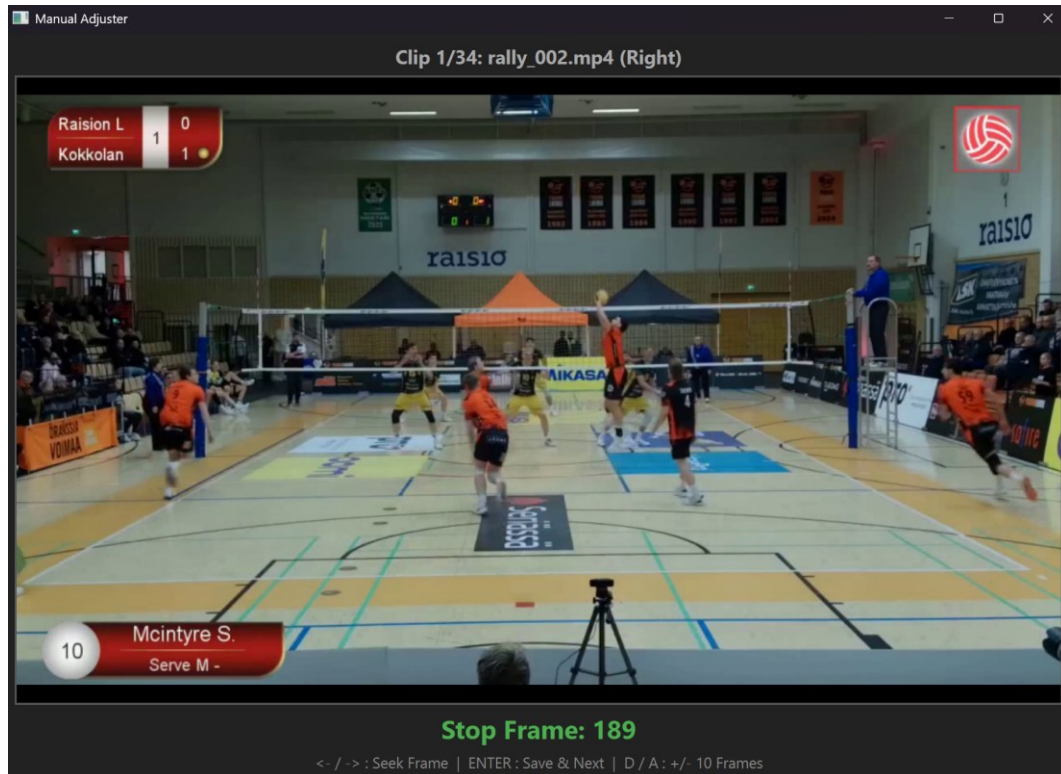
Kuva 4. Manuaalinen kalibrointityökalu (manual_adjuster.py).
