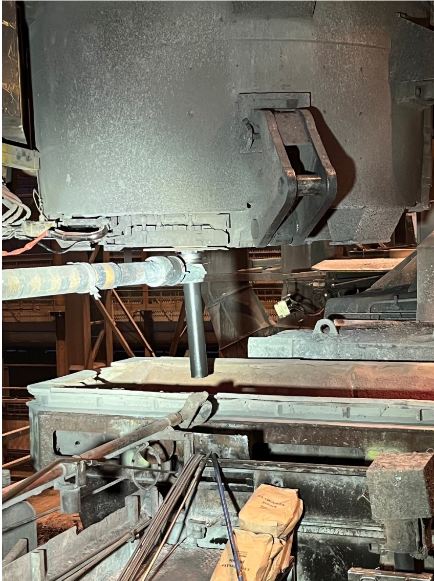
KUVA 12. Kuvassa robotti asentaa suihkunsuoja-putkea paikalleen.
